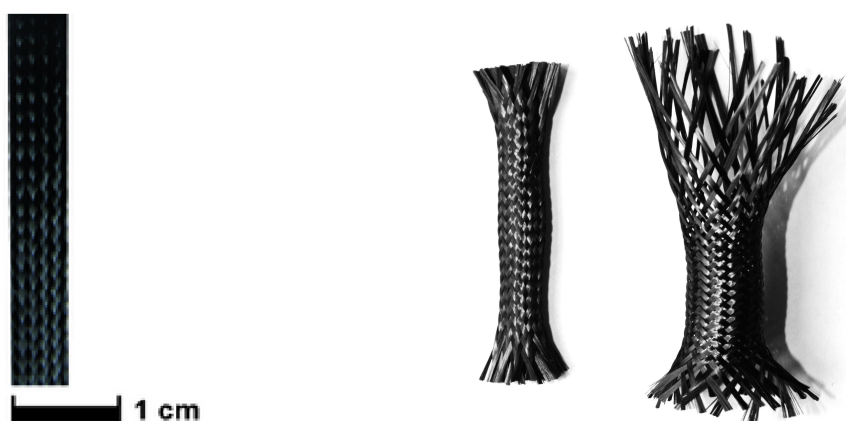
Figura 3-7: Manicotto di fibre di carbonio, usato per riprodurre l'osteone nella struttura bio-ispirata. A sinistra si può notare come il tipo d'intreccio permetta alle fibre di variare angolo e conseguentemente diametro del tubo.
