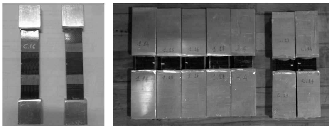
Figura 5-6: I provini pronti ad essere testati. A sinistra le provette per il test di trazione trasversale, a destra quelle di compressione trasversale
