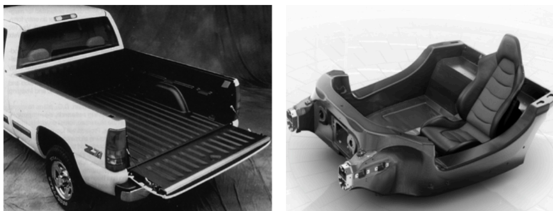
Figure 2-10: Vano di carico tutto in un pezzo realizzato in materiale composito (sinistra). A destra il telaio monoscocca in fibra di carbonio della McLaren Mp4 12C
