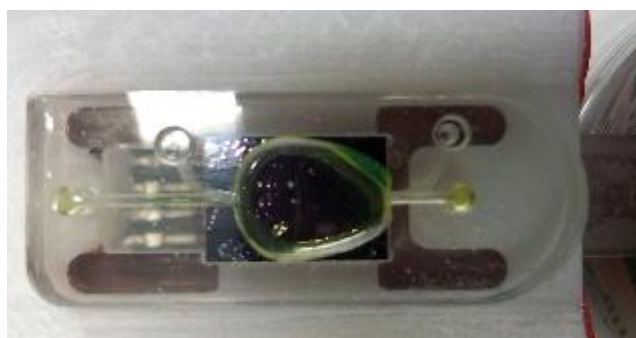
Figura 5. 11: svuotamento fase 4/4; la microcamera è totalmente svuotata.
