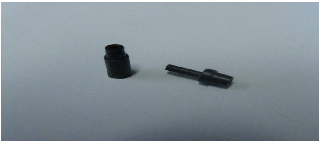
Figura 3. 17: Luer per l'ancoraggio del chip microfluidico allo strumento.
