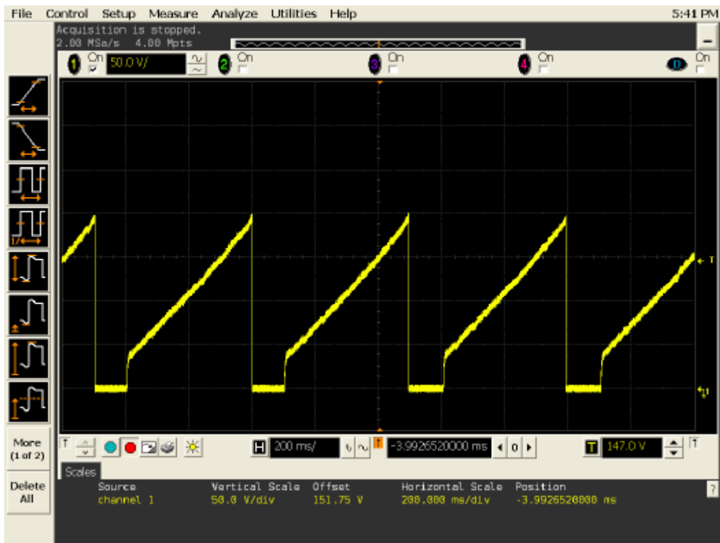
Figura 4. 18: Tensione di pilotaggio a dente di sega; la rampa presenta pochissimo rumore grazie al filtraggio effettuato.
