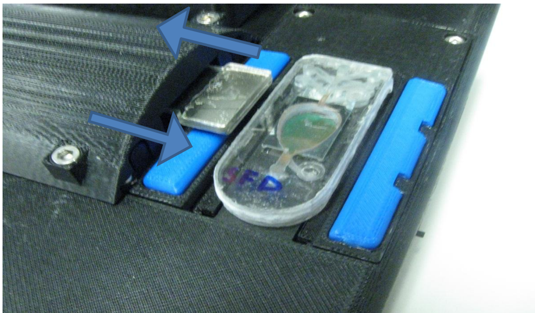
Figura 3. 21: Particolare dell'alloggiamento del chip sullo strumento; da notare il magnete pilotato dallo stepper.
