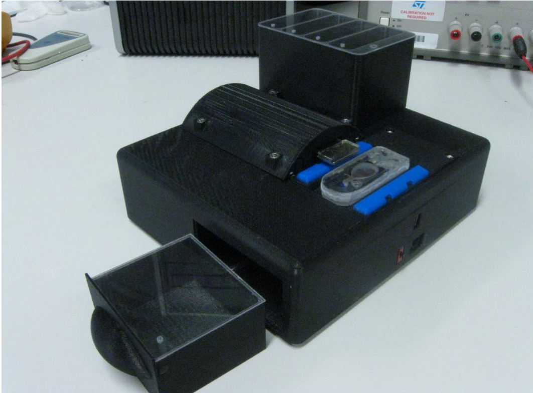
Figura 3. 1: Lo strumento: la cartuccia di WASTE in basso a sinistra è estraibile per permetterne lo svuotamento.
