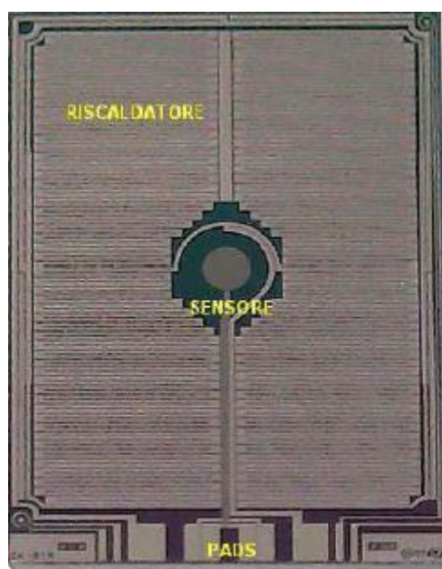
Figura 3. 19: Chip in silicio contenente sensori di temperatura e riscaldatori per permettere il trattamento in temperatura del campione all'interno della microcamera.
