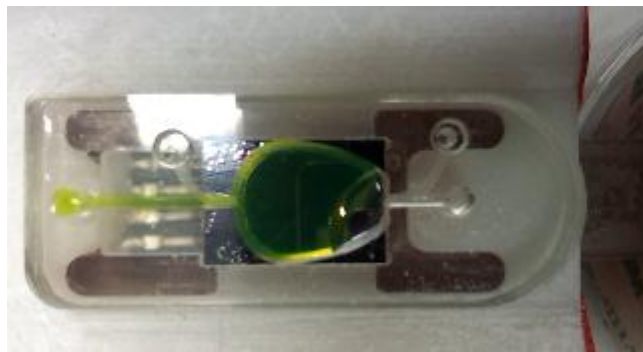
Figura 5. 6: riempimento della microcamera fase 4/5; la struttura evita la formazione di bolle.
