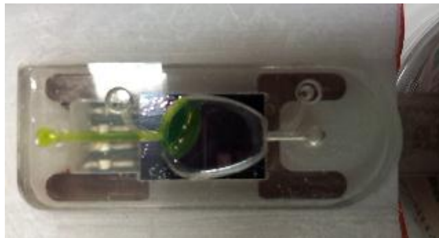
Figura 5. 4: Riempimento microcamera fase 2/5.
