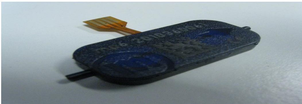
Figura 3. 13: La micropompa mp-6 della Bartels Mikrotechnik.
