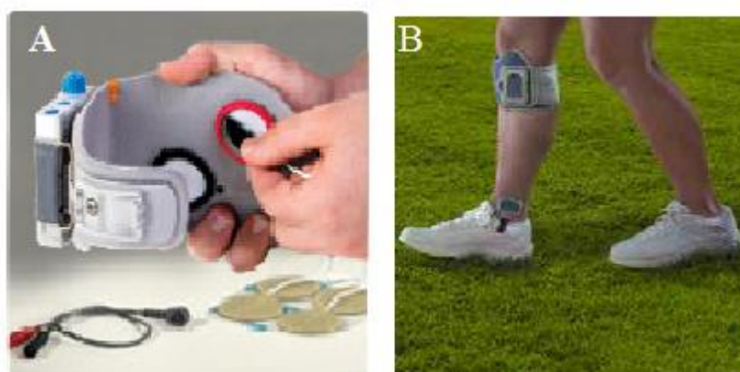
Figura 3: A) Walkaide con elettrodi e B) Ness L300 indossato ad un paziente
