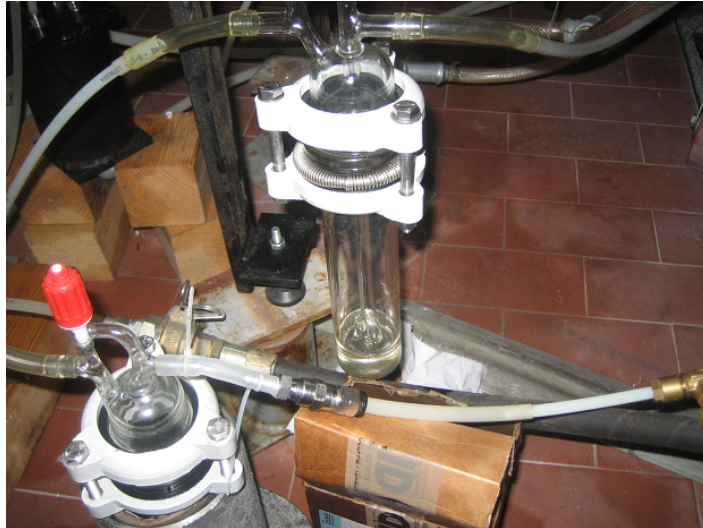
Figura 3.14: Sistema per nebulizzare ad aria compressa
