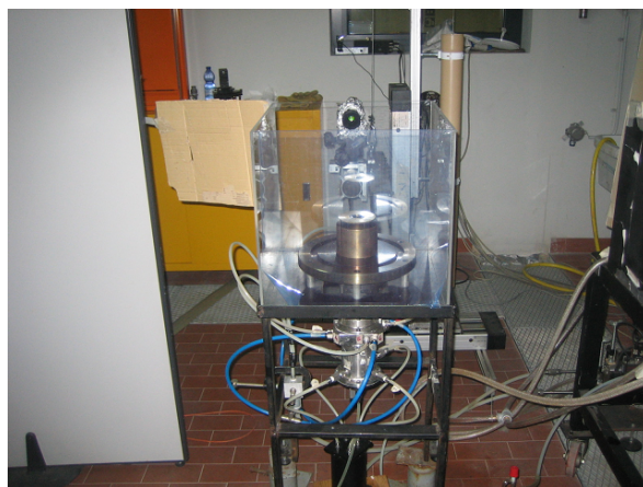
Figura 3.9: Seconda camera di combustione in plexiglass
