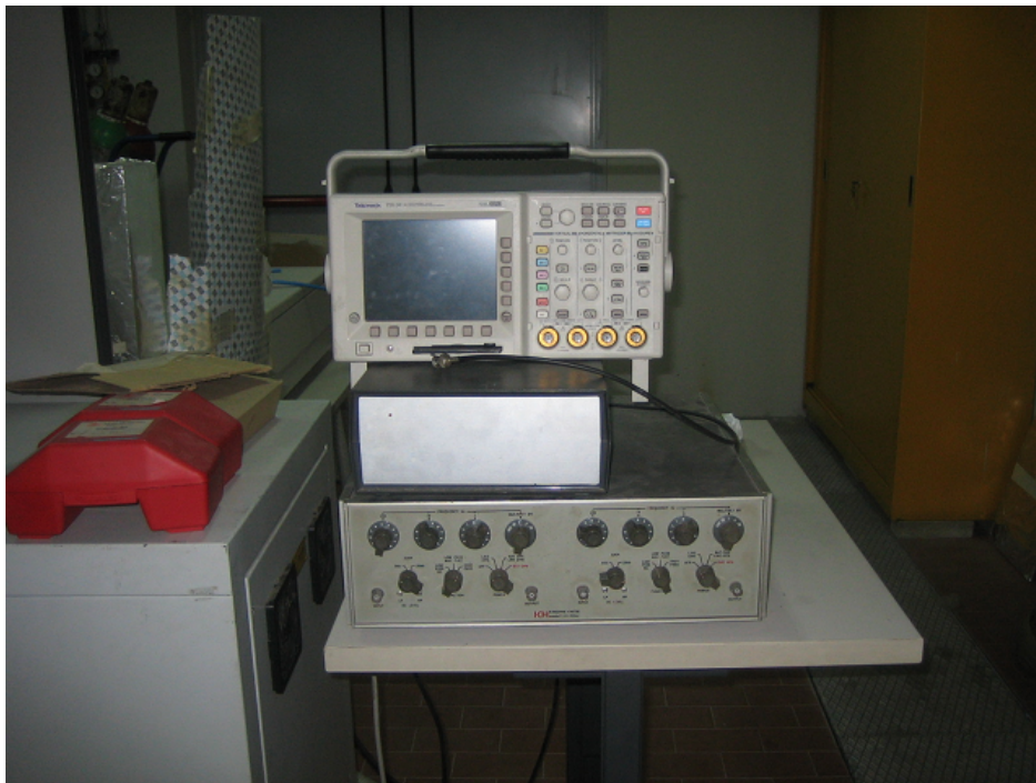
Figura 3.19: Insieme di filtro (basso), generatore TTL (centro) e oscilloscopio (alto)
