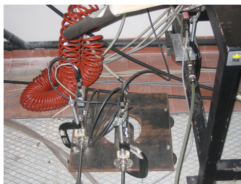
Figura 3.12: Regolatori di portata assiale, tangenziale e per l'inseminazione
