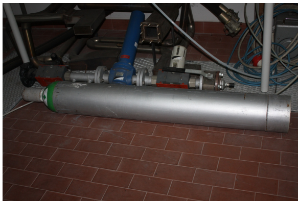
Figura 5.17: Bombola in pressione contenente miscela inerte con densità equivalente al metano.
