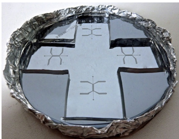
Fig. 3.1: wafer di silicio con microstrutture in rilievo ottenute per fotolitografia. Sono presenti 4 strutture, ciascuna delle quali permette di realizzare un dispositivo. Tra le strutture è presente del silicone, residuo di colate precedenti.
