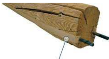
Figura 6.12 Inserimento di elementi cfrp
