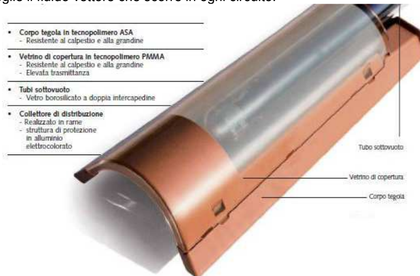
Figura 8.4 Il coppo solare
