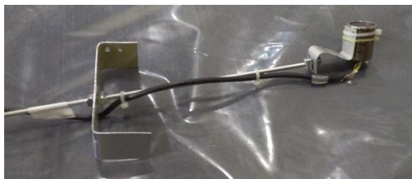
Figura 30: Sonda GM per analisi superficiali interne
