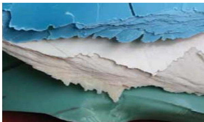
Figura 3: Tubo verde (PVC-U tradizionale) Tubo bianco e Tubo blu (PVC Bi-Orientato)
