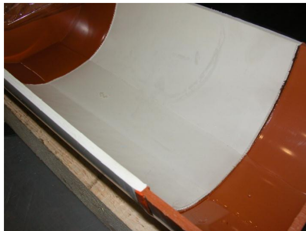
Figura 32: vaschetta con soluzione contaminante
