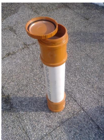
Figura 27: tronco di tubo per prove dinamiche
