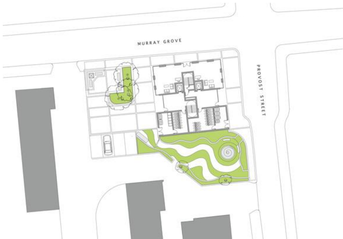
Fig. 111: Pianta piano terra – Ingresso est per appartamenti sul libero mercato Ingresso ovest per alloggi in social housing
