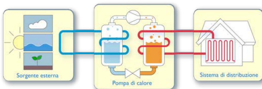
FIGURA 64 - SCHEMA DI IMPIANTO A POMPA DI CALORE
