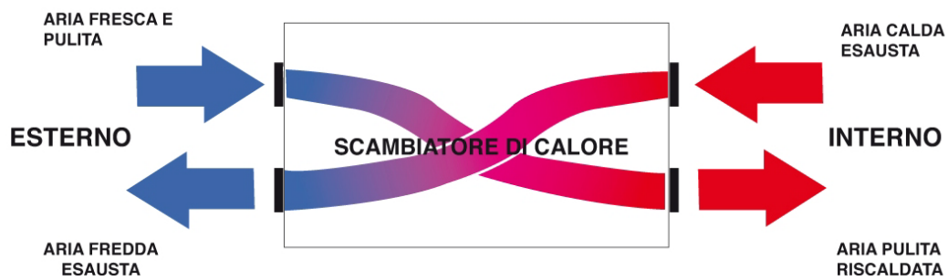
FIGURA 61 - SISTEMA DI VENTILAZIONE A DOPPIO FLUSSO
