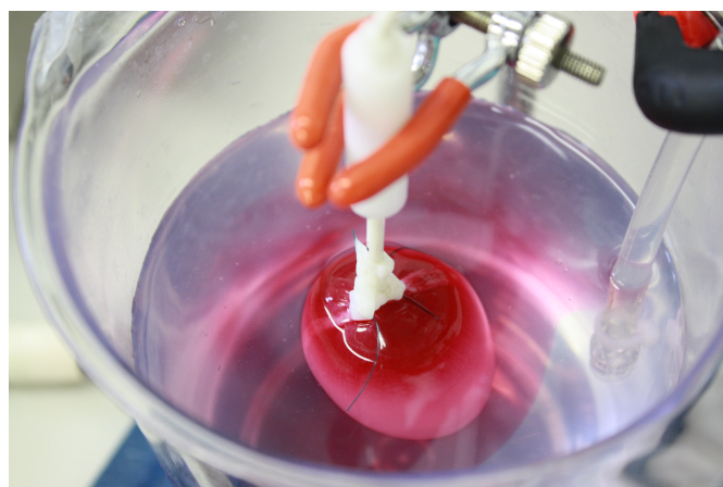
Figura 4.8: Prova di cistometria su vescica decellularizzata con perfusione con acqua colorata. In figura è chiaramente visibile l'ultrafiltrazione del liquido immesso attraverso le pareti della vescica, che quindi caratterizza la BAM come una matrice permeabile.
