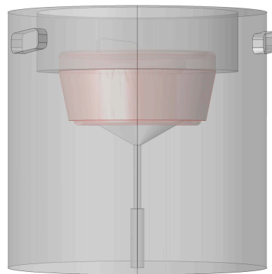
Figura 3.18: Modello geometrico assemblato utilizzato nelle simulazioni del sistema a perfusione per la sollecitazione meccanica del patch: la cartuccia viene mostrata (in rosso) all'interno dell'apposita sede all'interno della camera.
