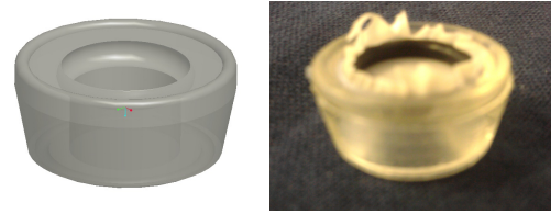
Figura 5: Cartuccia modificata, senza o-ring in disegno CAD (a sinistra) e con o-ring che fissa il patch (a destra).
