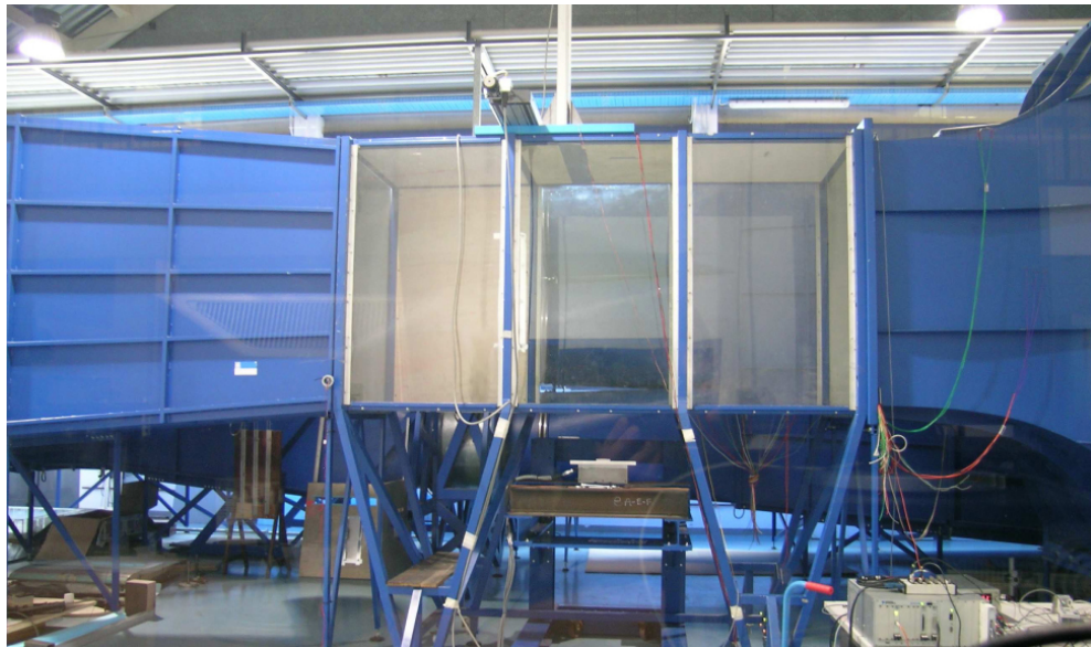
Figura 3.1: Camera di prova della galleria del vento a circuito chiuso presso il Laboratorio Aerodinamico del Politecnico di Milano
