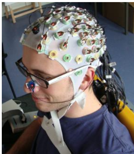
Figura E.2: Cuffia con 62 elettrodi collocati sullo scalpo dell'autore per un esperimento di BCI basato su EEG.
