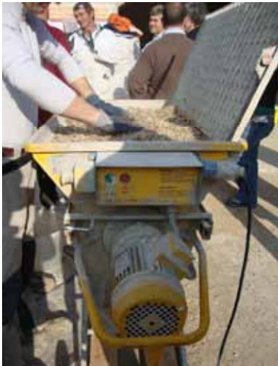
Fig. 3.55-3.56-3.57 Miscelatore a vite senza fine da cantiere Casatenovo, arch. S.Sabbadini
