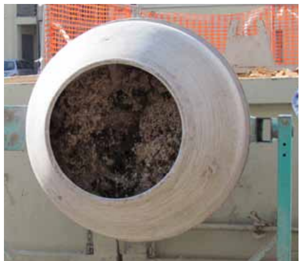
Fig. 3.59 Impasto per la realizzazione di un massetto calpestabile, miscelatore ad asse planetario, Batiethic
