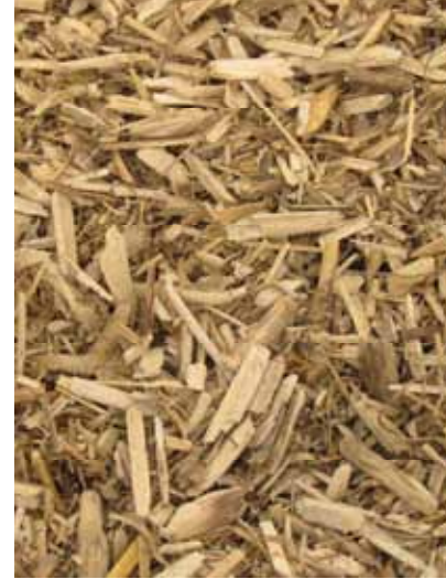
Fig. 2.5 Canapulo grosso con lunghezza tra i 20 e i 30 mm
