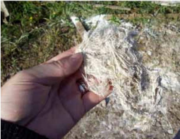
Fig. 3.123 Canapulo molto fibroso
