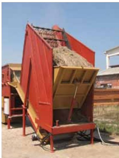
Fig. 2.9 Impianto Assocanapa, modulo di alimentazione
