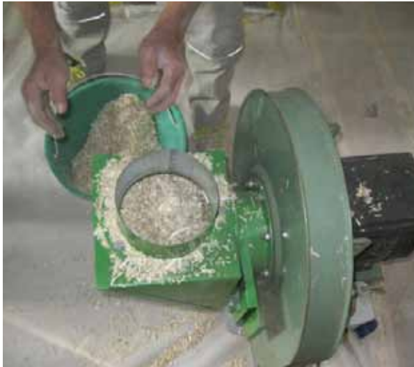
Fig. 3.49-3.50 Macchina insufflatrice, prove insufflaggio di canapulo, Arch. S.Sabbadini
