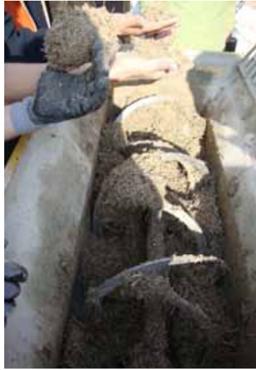
Fig. 3.55-3.56-3.57 Miscelatore a vite senza fine da cantiere Casatenovo, arch. S.Sabbadini
