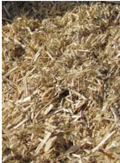
Fig. 2.4 Canapulo medio con lunghezza tra i 10 e i 20 mm
