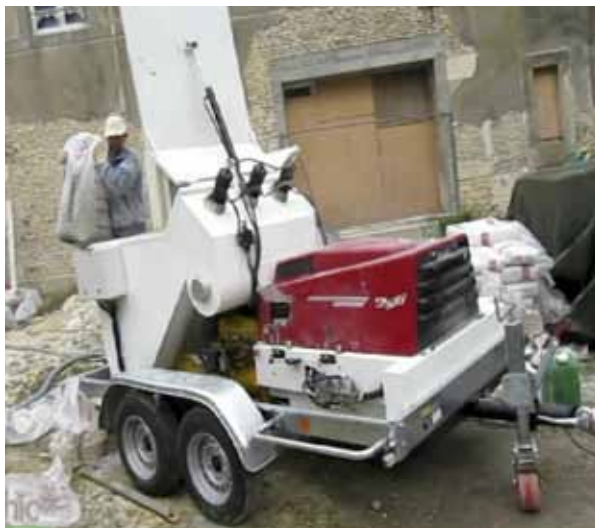
Fig. 3.51 Macchina a spruzzo di Batiethic , alimentazione
