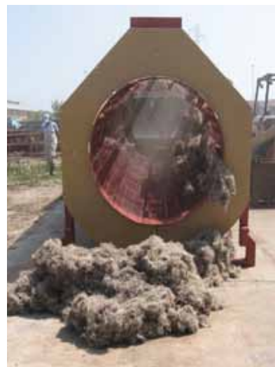
Fig. 2.11 Impianto Assocanapa, modulo di pulizia
