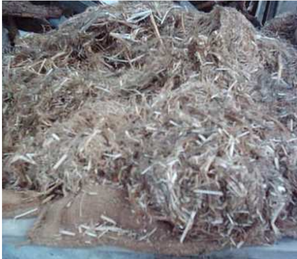
Fig. 1.25 Fibra grezza e canapulo per la realizzazione della malta per il sistema costruttivo Casa Coltivata
