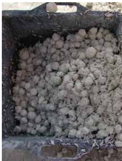
Fig. 3.63 consistenza errata, formazione di pallottole
