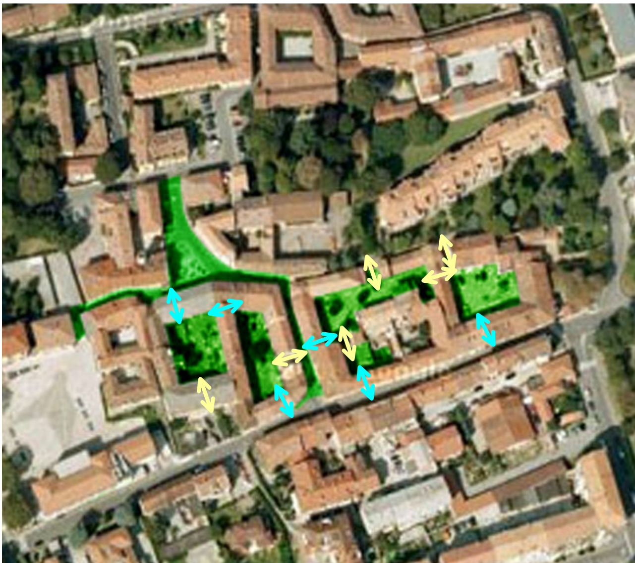
Figura 14. Pianta dell'area oggetto dell'intervento: in azzurro sono indicati i passaggi esistenti, in giallo quelli da realizzare.
