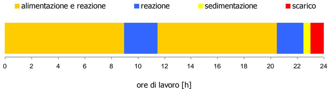
**Figura 3.10 - Struttura del ciclo di lavoro dell'SBR, 1° periodo**
