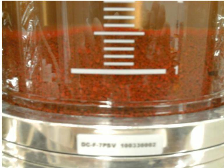
**Figura 3.14 – Inoculo granulare anammox presente all'interno del reattore SBR**
