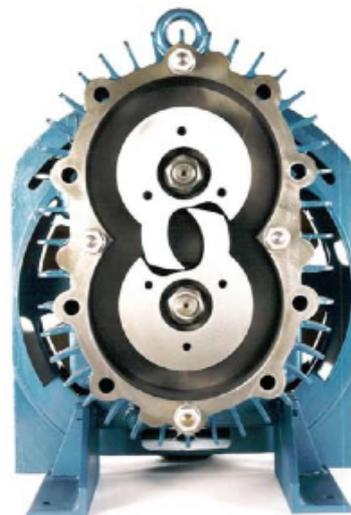
Figura 2.1: Compressore a camme di costruzione "Northey".
