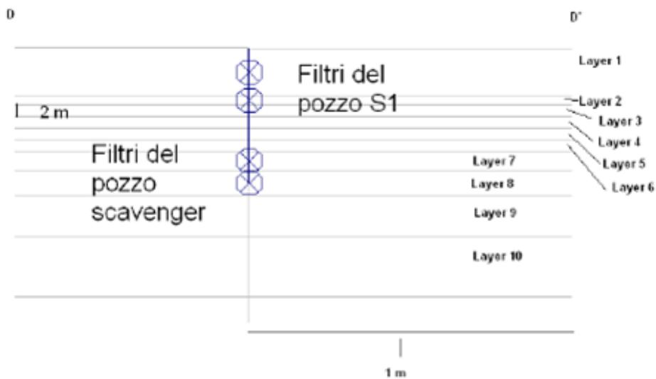
Figura 5.8: Sezione trasversale (ingrandimento nell'intorno di S1 della sezione DD') raffigurante la posizione dei filtri del pozzo *scavenger* sulla medesima verticale.
