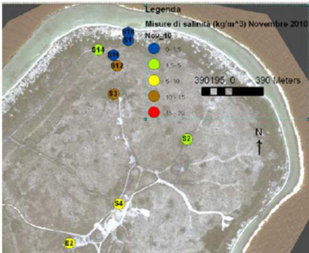
Figura 4.14: Carta delle misure di salinità relative al dominio del modello effettuate a Novembre 2010 [kg/m<sup>3</sup>].
