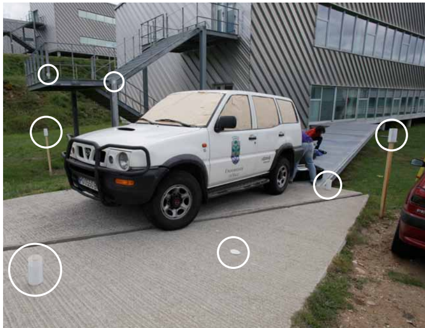
Fig.3.1.4 _ Alcuni dei target utilizzati per il rilievo della vettura
