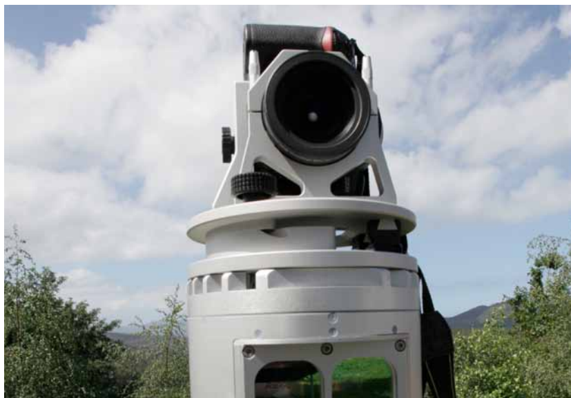
Fig.3.2.1 _ Dettaglio camera Nikon D200 montata sul Riegl LSM Z930i
