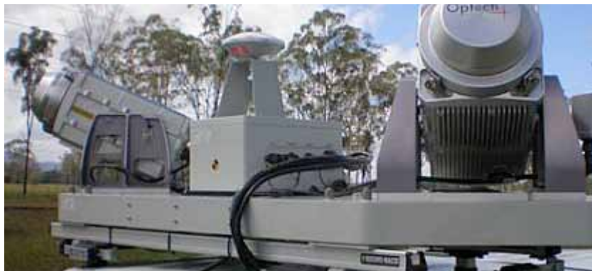
Fig.1.3.4.4 _ IMU posizionato tra i laser e le camere, sulla piattaforma di montaggio
