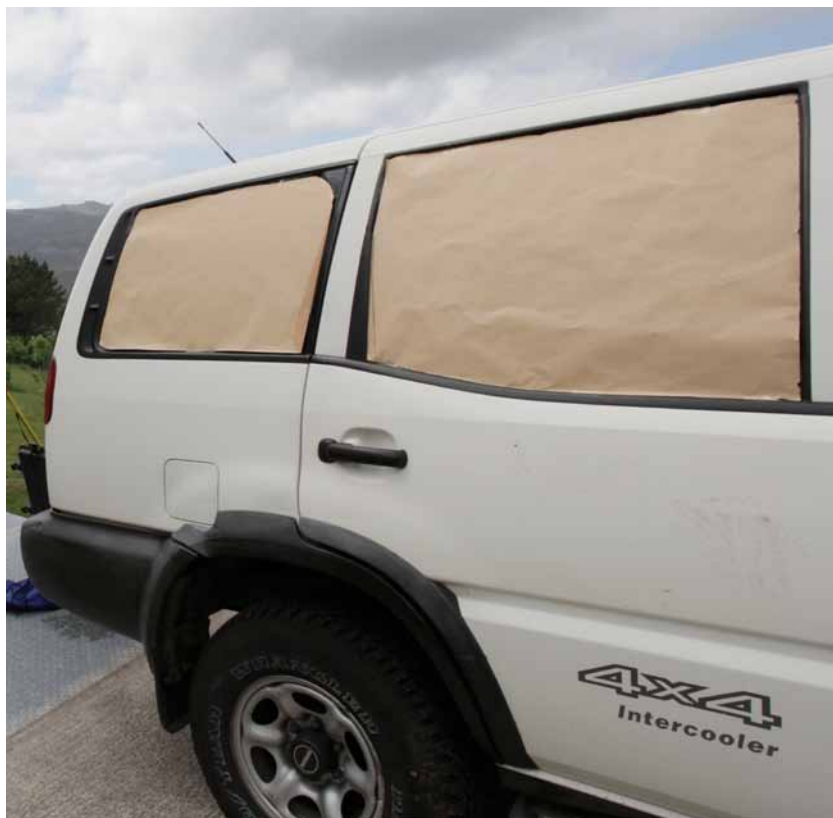
Fig.3.1.5 _ Dime in cartone posizionate sui vetri per evitare effetti indesiderati in fase di acquisizione
