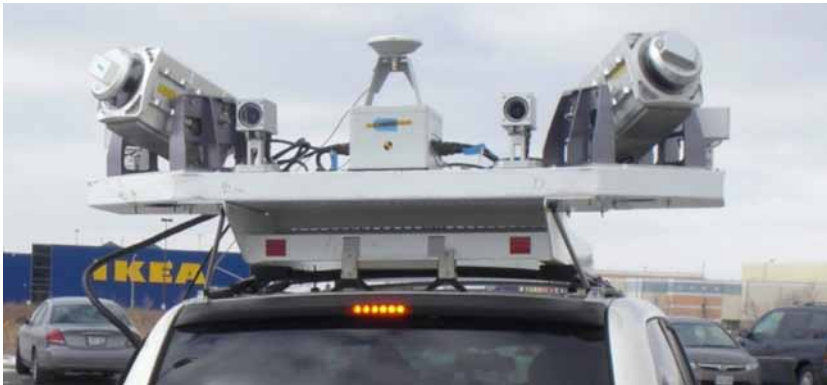
Fig.1.3.4 _ Piattaforma con radar, camere e GPS sul tettuccio
