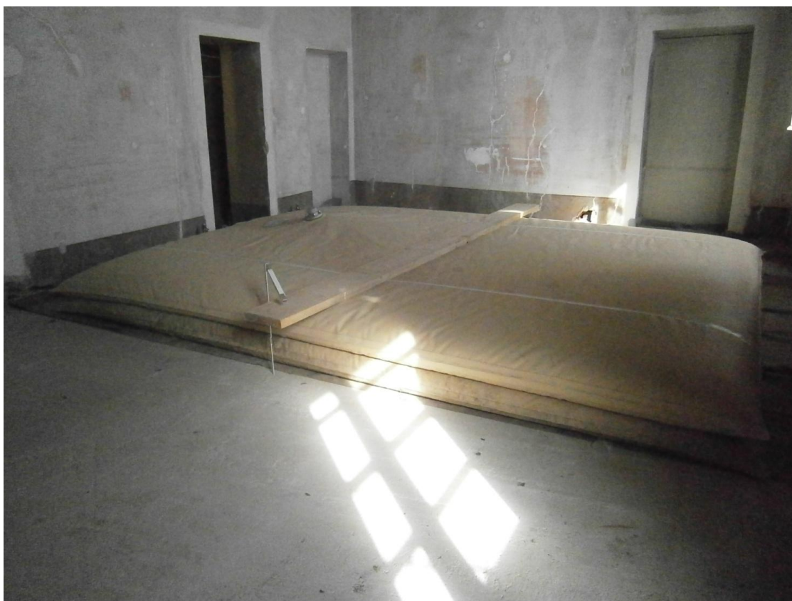
Figura 124 - Misurazione dell'altezza raggiunta dall'acqua nei serbaoi
