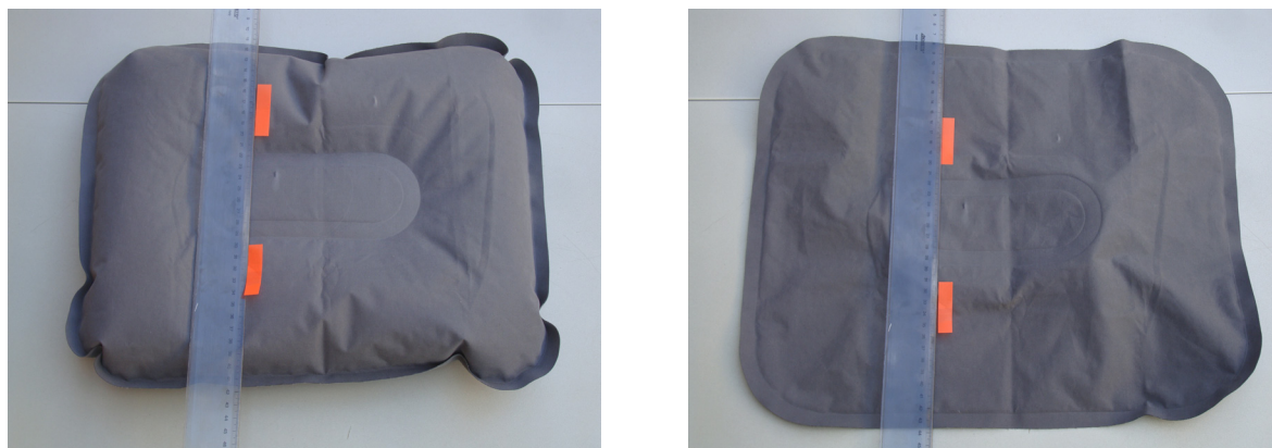
Figura 80: Avvicinamento e allontanamento di due punti a seguito del gonfiaggio e dello sgonfiaggio del cuscino
