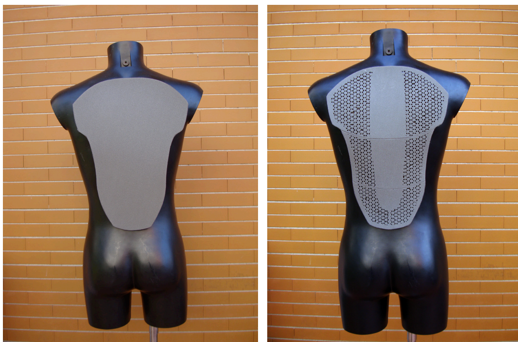
Figura 120: Confronto di adattabilità alle forme della schiena tra il paraschiena senza texture auxetica e quello con texture chirale
