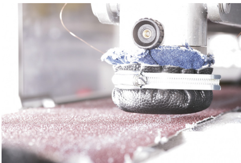
Figura 20: Macchina per il test di abrasione/impatto in funzione
