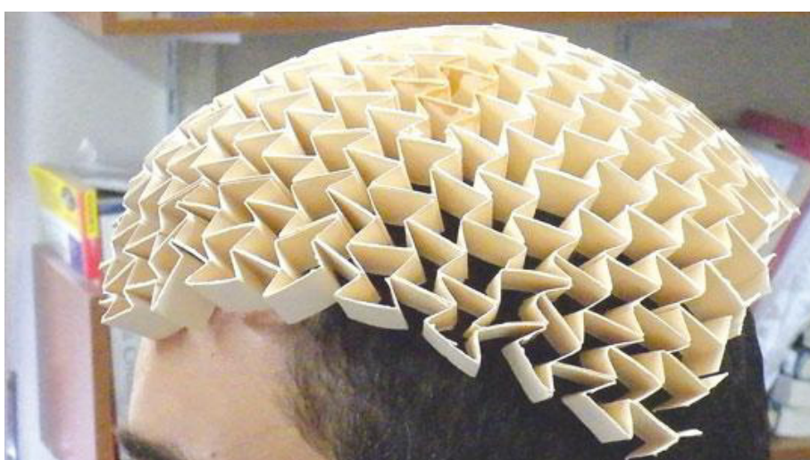
Figura 92: Doppia curvatura assunta da una struttura auxetica
