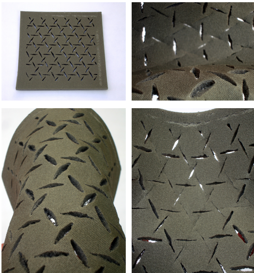
Figura 122: Prove di flessione del prototipo di pattern auxetico rotativo in scala maggiorata
