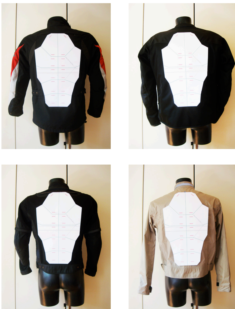
Figura 53: Sagoma paraschiena maggiorata testata sulle diverse giacche
