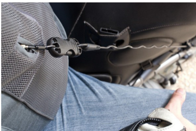
Figura 41: Connessione tramite cavo spiralato del protettore airbag
