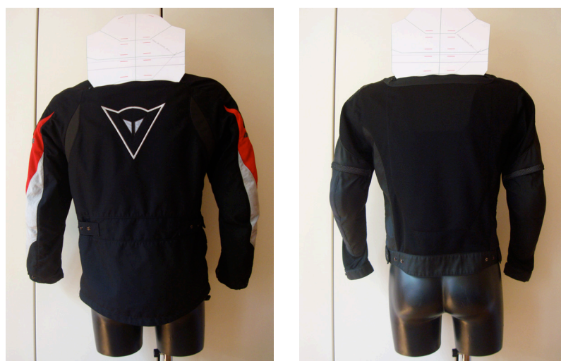
Figura 55: Test posizionamento del paraschiena maggiorato nella giacca invernale e in quella estiva
