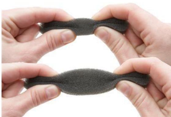
Figura 85: Materiale auxetico (a sinistra) e una struttura auxetica (a destra)
