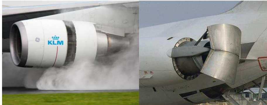
Figura 4 : Tipologie di inversori di spinta per motori turbofan, a scorrimento del nacelle (sinistra) e a conchiglia (destra)
