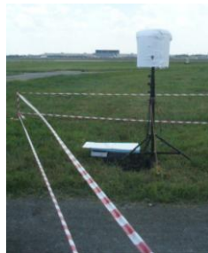
Figura 37 : Sonda di misurazione dell'intensità con copertura protettiva
