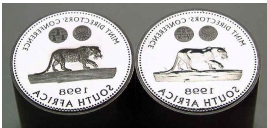
Figura 1.8. Incisione profonda di stampi per la coniazione di monete.
