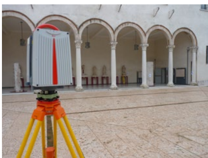
Fig. 33 | Laser HDS 6000 in azione nel cortile del palazzo.
