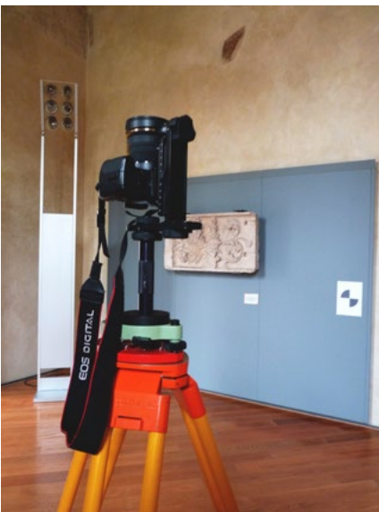
Fig. 49 | Acquisizioni fotografiche del Museo tramite Canon EOS 350D con obiettivo fish-eye da 8 mm, montata su braccio a rotazione manuale (Nodal Ninja). Cortile e Sala del Porcospino.
