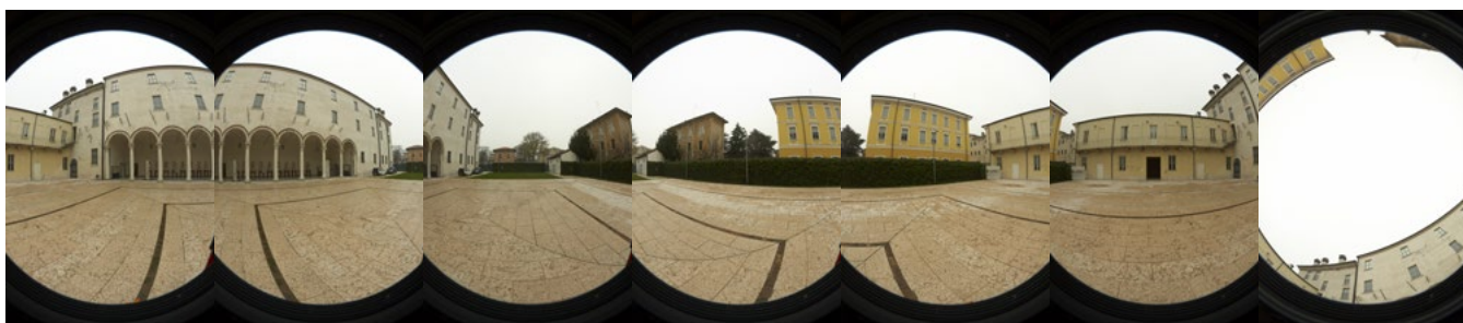
Fig. 50 | Le sette prese fotografiche eseguite con camera Canon EOS 350D e con obiettivo fish-eye da 8 mm, acquisite per colorare la nuvola di punti corrispondente nel cortile.
