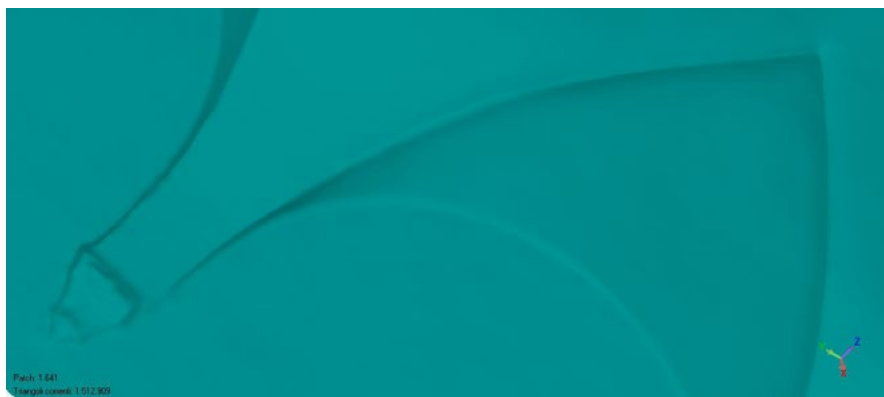
Fig. 94 | Superficie della volta della Sala del Porcospino generata con il software Geomagic Studio 12.
