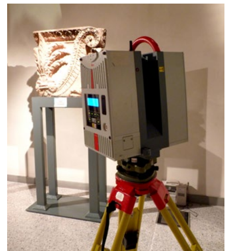
Fig. 38 | Acquisizione laser HDS 6000 nella Sala dei Trionfi. Data la lunghezza dell'ambiente sono state effettuate due scansioni. Sono visibili i target distribuiti nella Sala.
