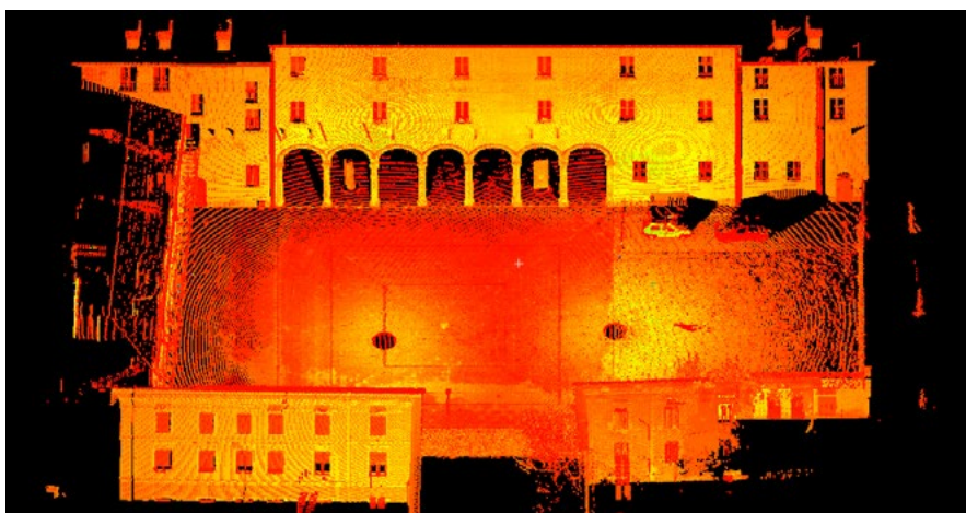
Fig. 23 | L'unione delle due nuvole di punti dei prospetti del cortile interno ha permesso di ottenere una maggiore completezza del dato. Visualizzazione delle due scansioni unite.
