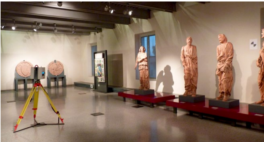
Fig. 38 | Acquisizione laser HDS 6000 nella Sala dei Trionfi. Data la lunghezza dell'ambiente sono state effettuate due scansioni. Sono visibili i target distribuiti nella Sala.
