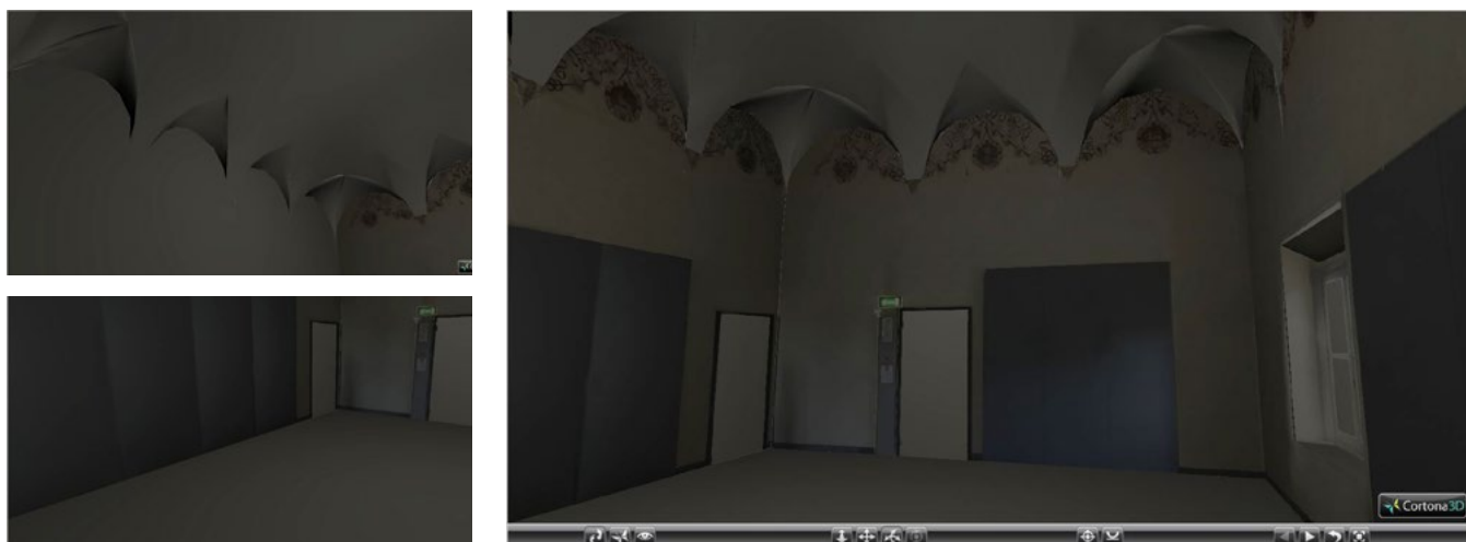
Fig. 107 | Sala delle Frece visualizzata in Cortona 3D Viewer. La navigazione risulta lenta e di non agevole gestione e l'ambientazione appare buia nonostante siano state impostate delle luci in ambiente 3DStudio Max. Una parete, il pavimento e tutta la superficie della volta mancano di texture.
