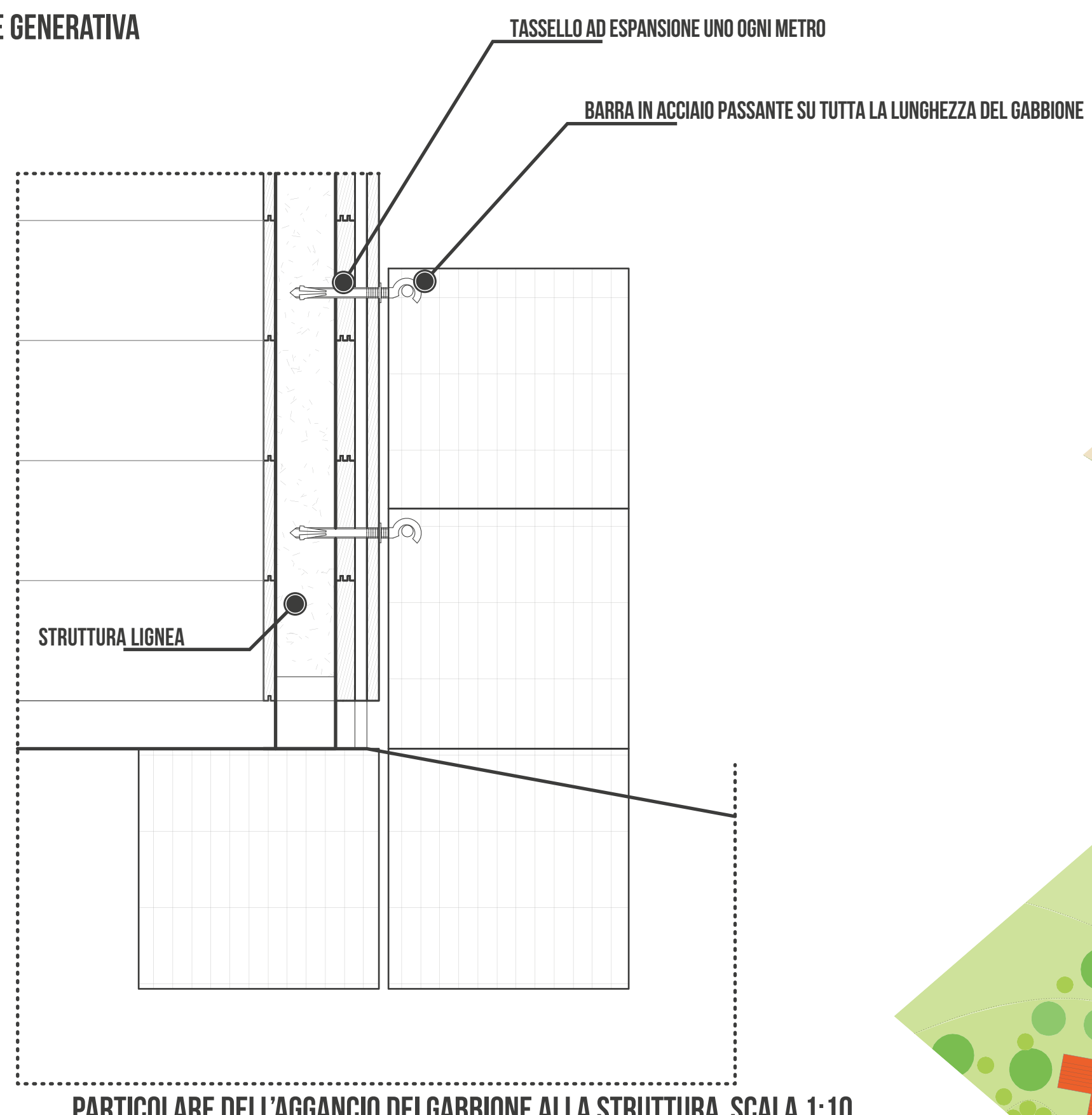
PARTICOLARE DELL'AGGANCIO DEI GABBIONE ALLA STRUTTURA SCALA 1:10
