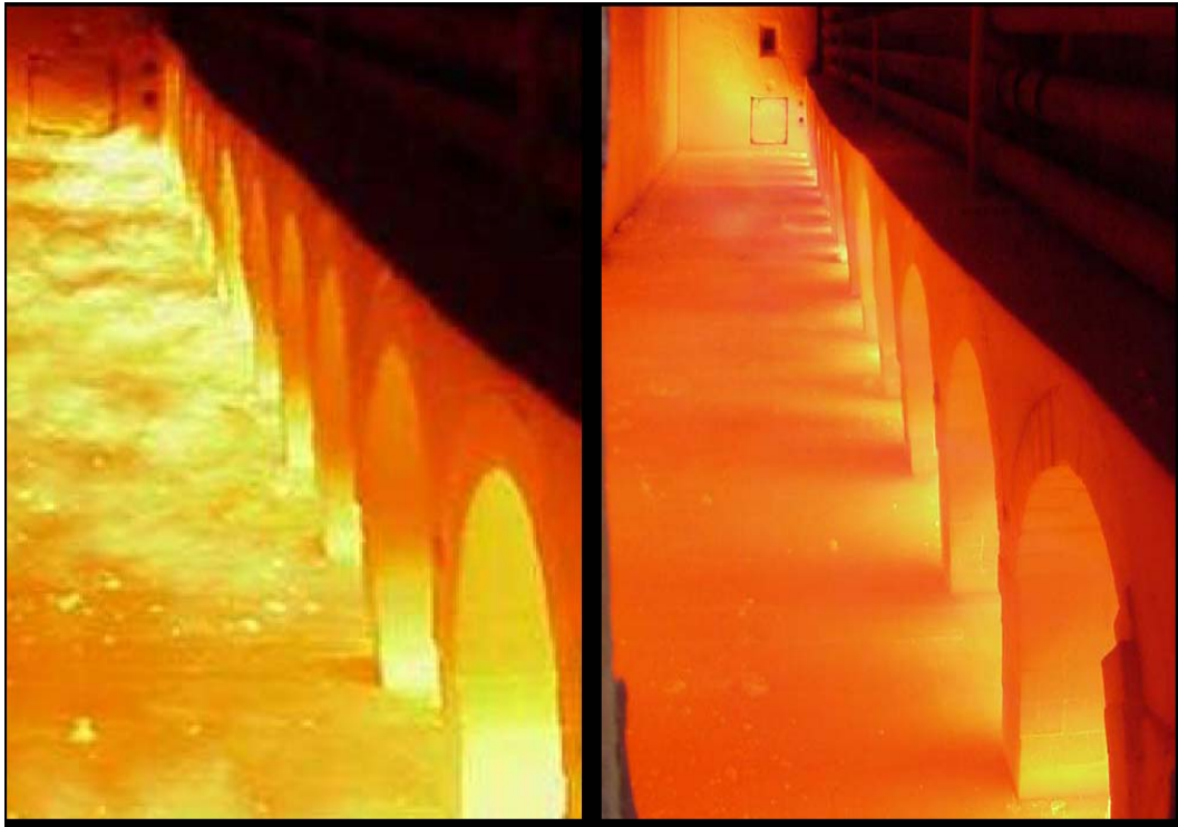
Figura 5 camera di combustione prima e dopo l'applicazione di misure primarie
