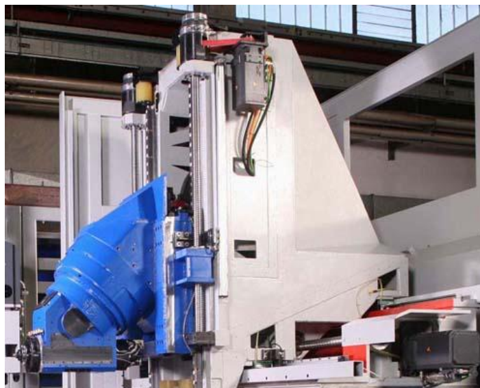
Figura 1.2 Asse Y della macchina Mandelli Spark 2100.
