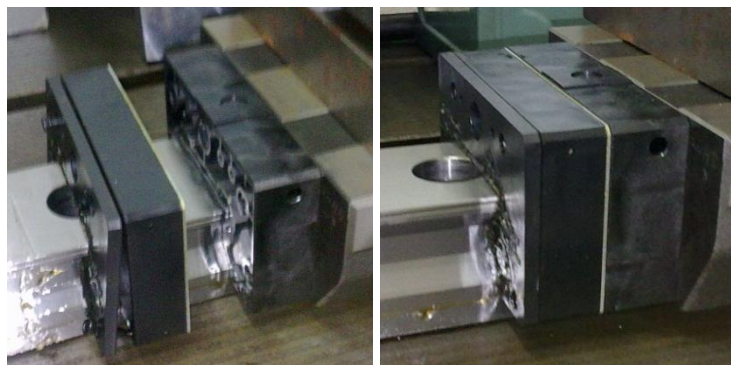
Figura 3.5 Guarnizioni montate e smontate dal pattino.
