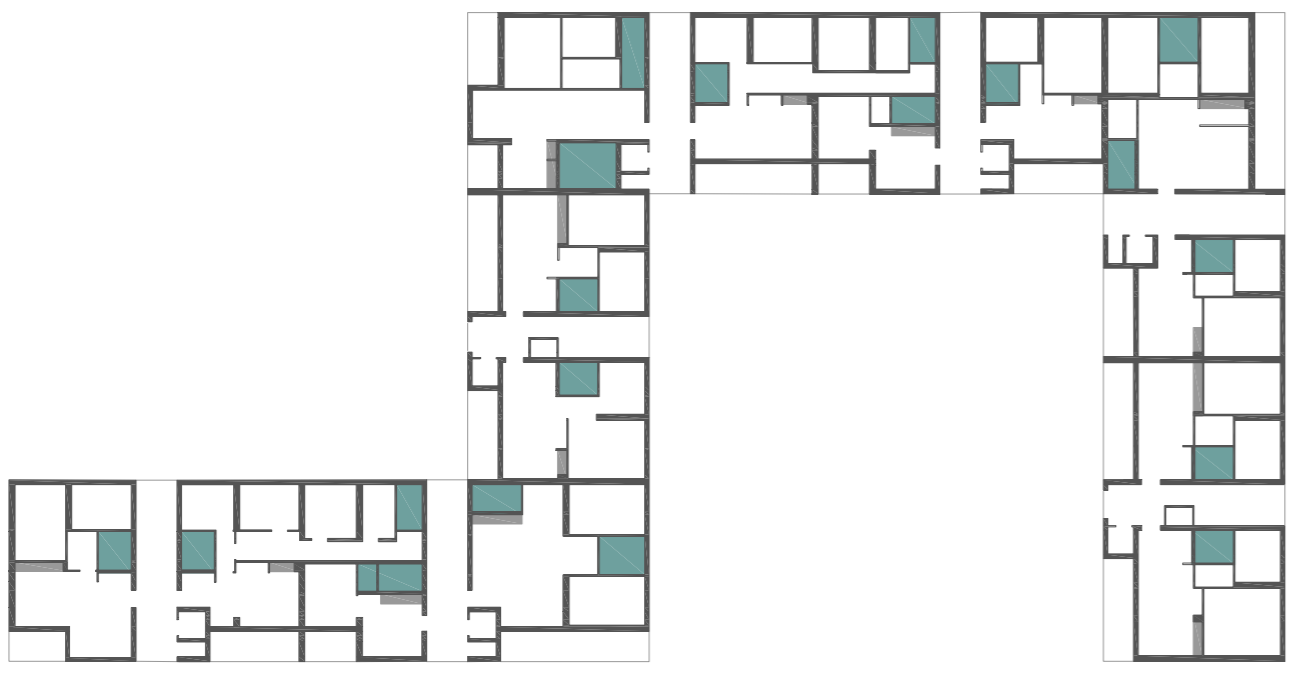
Disposizione moduli umidi: bagni e cucine
