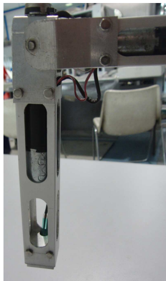
Figura 2.8 : Particolare sulla disposizione dei motori
