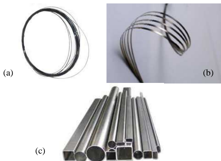
Figura 3.12 : Forme in cui si può presentare il NiTi (a) Fili (b) Nastri (c) Tubi
