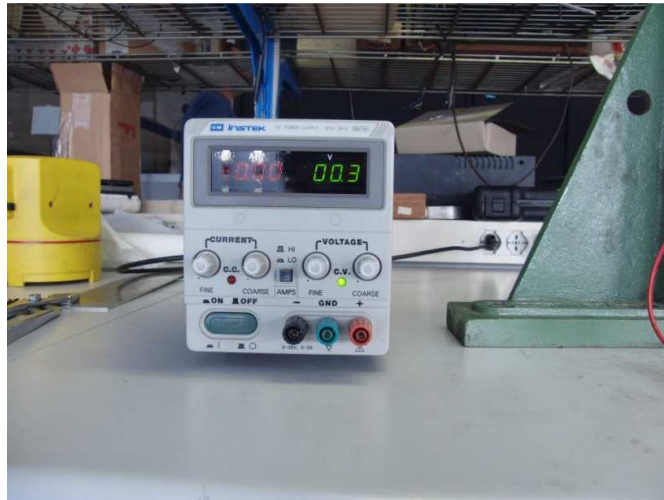
Figura 5.21 : Alimentatore utilizzato - GW-INSTEK SPS-3610
