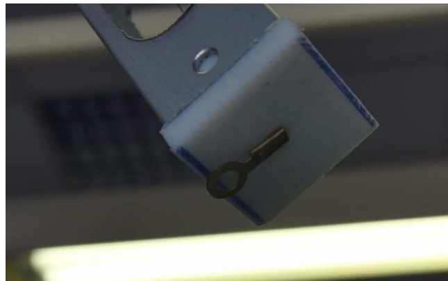
Figura 5.15 : Crimpaggio filo all'estremità inferiore
