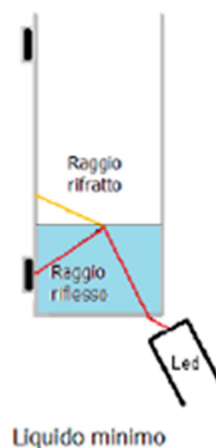
Figura 1.2 – Configurazione ottica del sistema di misura
