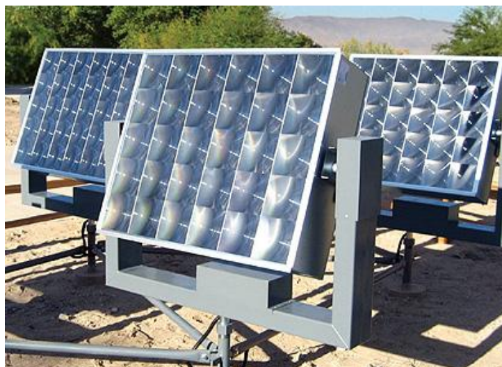
Figura 3.9 Sistema fotovoltaico ad alta concentrazione.
