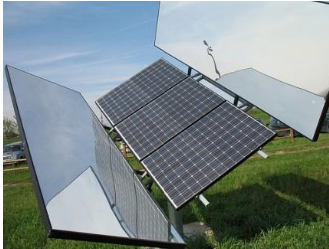
Figura 3.7 Sistema fotovoltaico a bassa concentrazione.
