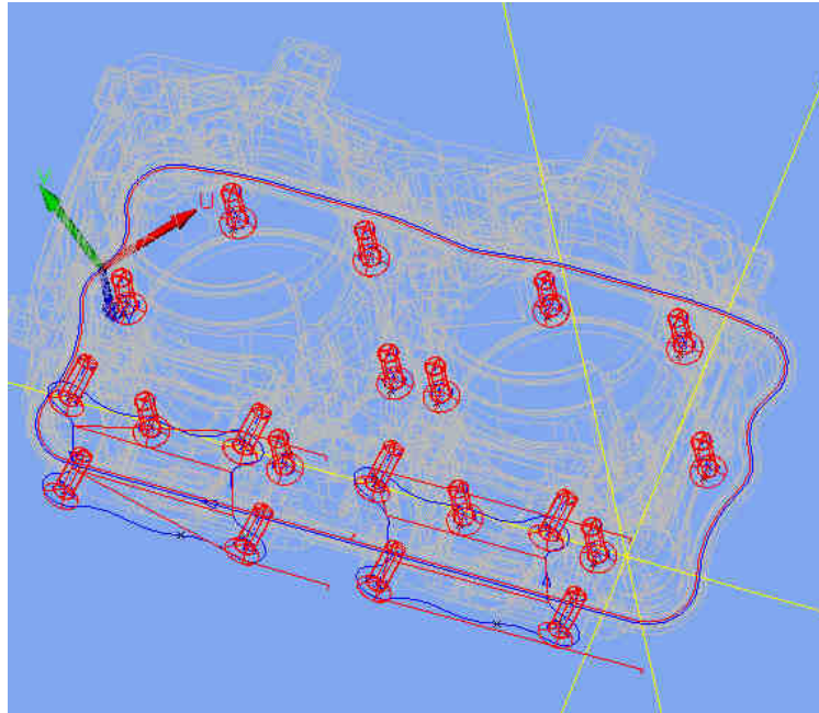
Figura 5.12 Componente 492 in ambiente Esprit. Si possono vedere i percorsi utensile previsti per realizzare le lavorazioni.
