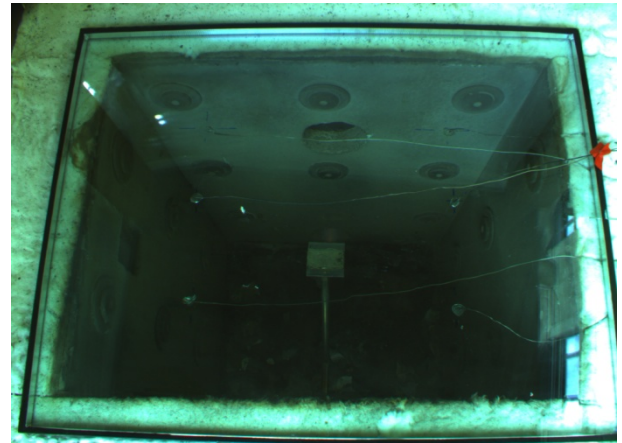
Figura 754 - Step 605 vetro stratificato, dopo aver spento l'incendio della pellicola PVB
