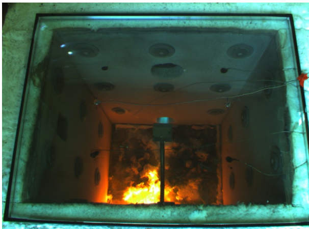
Figura 757 - Step 117 vetro temperato, accensione della fiamma
