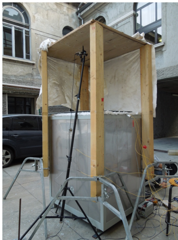
Figura 740 - Forno con strutture anti-riflesso
