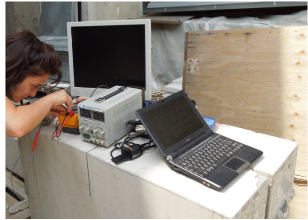
Figura 734 - Preparazione strumenti di lavoro: computer, schermo grande, multimetro, alimentatore, condizionatore-amplificatore per termocoppie
