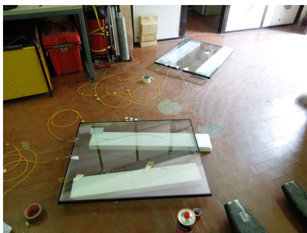
Figura 731 - I due vetrocamera con sonde applicate sulla superficie interna
