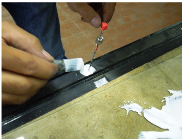
Figura 730 - Sigillatura del foro
