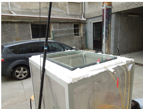
Figura 737 - Disposizione del vetro sul forno
