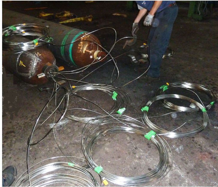
Figura 5.14: Matasse delle termocoppie da srotolare
