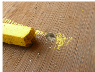
Figura 5.5: Fori per il posizionamento delle termocoppie nello spessore del bombolone
