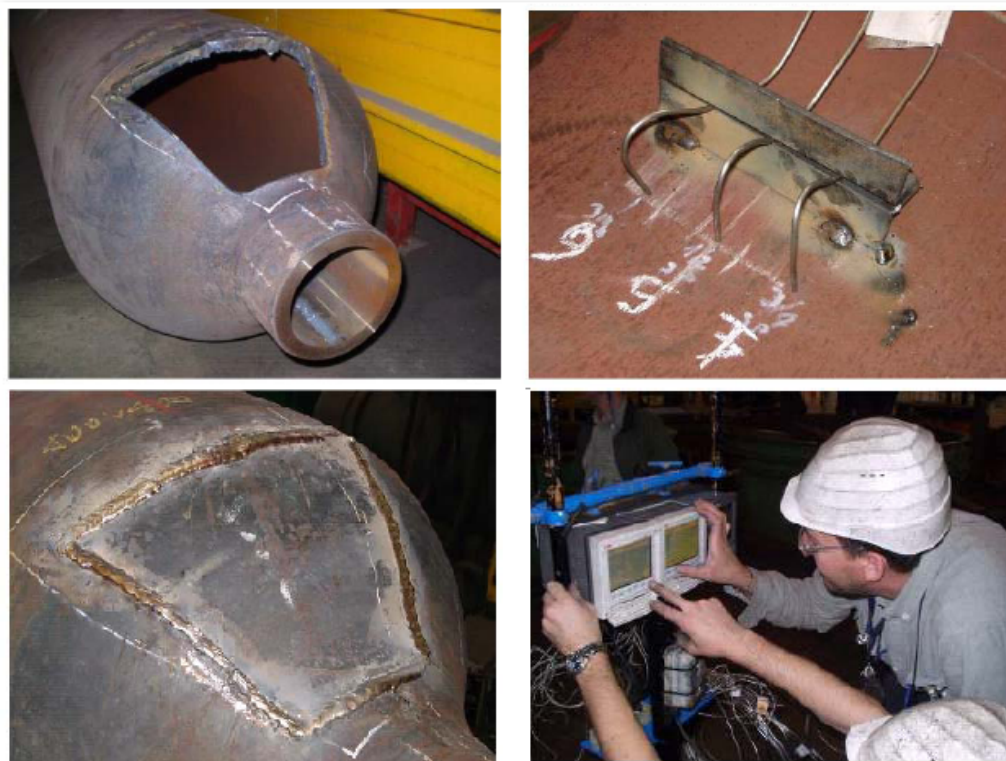
Figura 3.12: Strumentazione del bombolone
