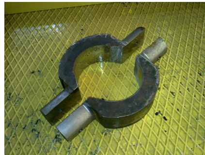
Figura 5.3: Cravatta per fissaggio dei bomboloni alla struttura di trattamento in doppio
