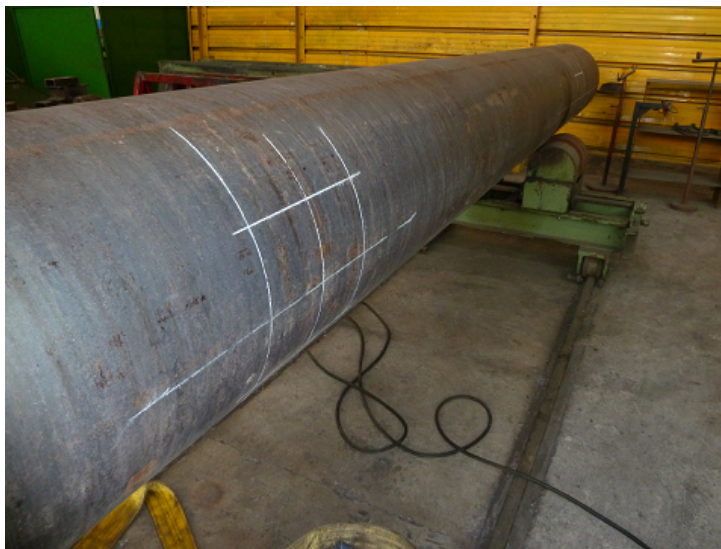
Figura 5.7: Individuazione della posizione delle termocoppie sul bombolone
