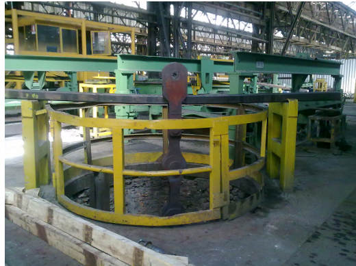
Figura 1.21: Bombolone inserito nel pozzo per il raffreddamento in aria calma
