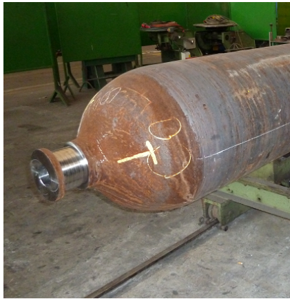
Figura 5.2: Tornitura dei bocchelli
