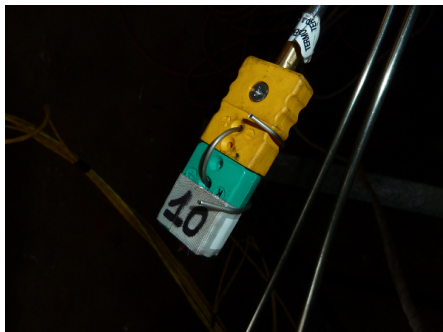
Figura 5.16: Collegamento delle termocoppie al registratore
