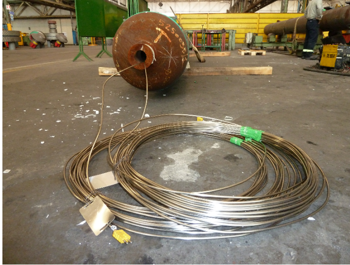
Figura 5.9: Inserimento termocoppie all'interno del bombolone
