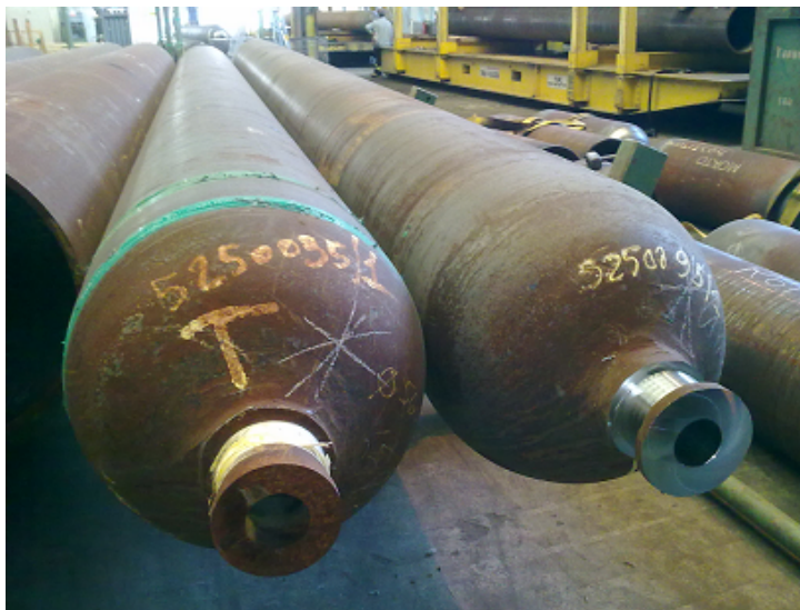
Figura 5.1: Bomboloni per la prova strumentata
