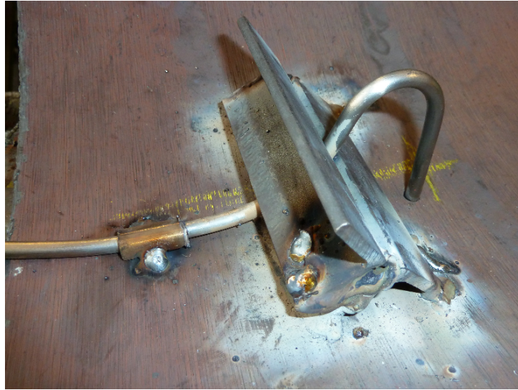
Figura 5.11: Fissaggio termocoppie con un supporto saldato al bambolone
