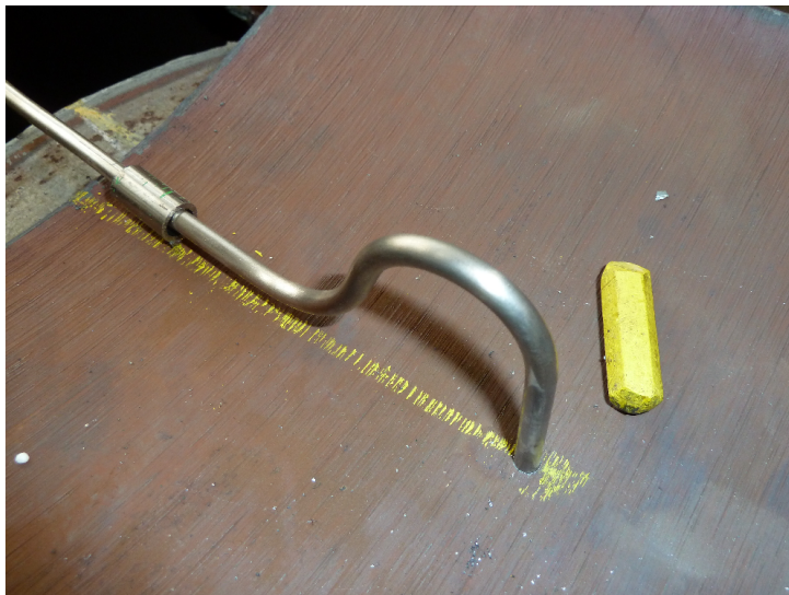
Figura 5.10: Posizionamento delle termocoppie
