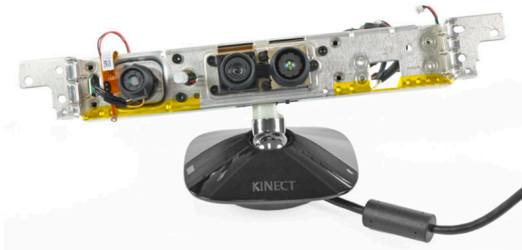
Figura 7 - Kinect senza rivestimento plastico esterno
