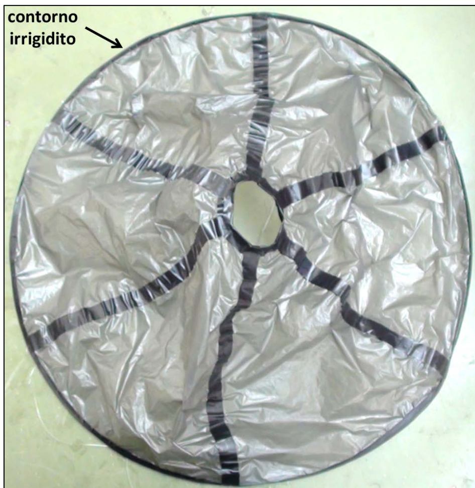
Figura 42: paracadute-pilota realizzato con contorno irrigidito
