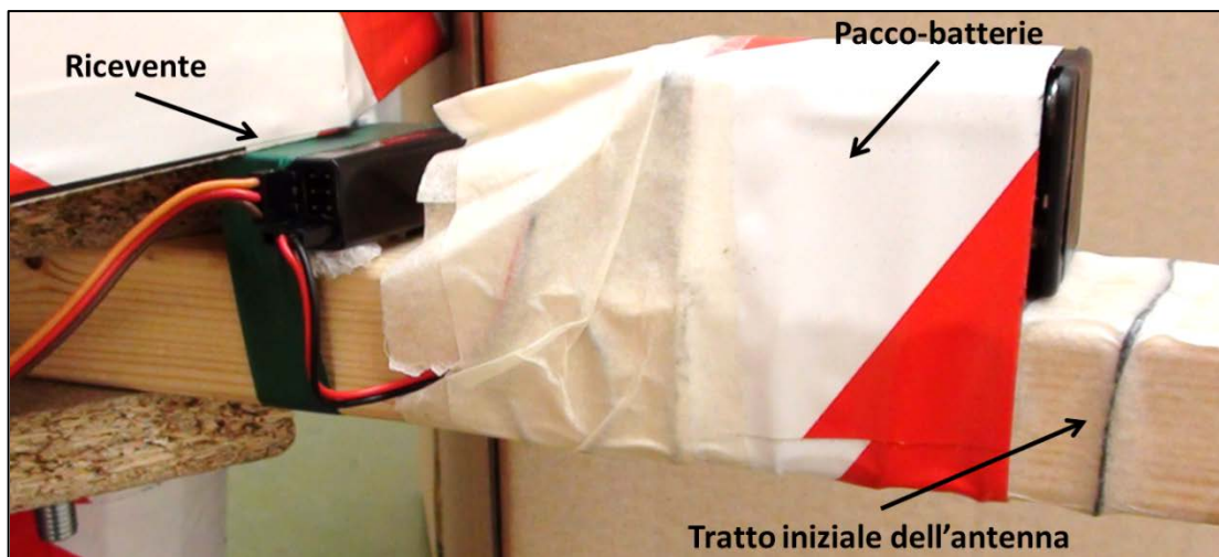
Figura 37: componenti necessari a bordo del mock-up per comandare lo sgancio
