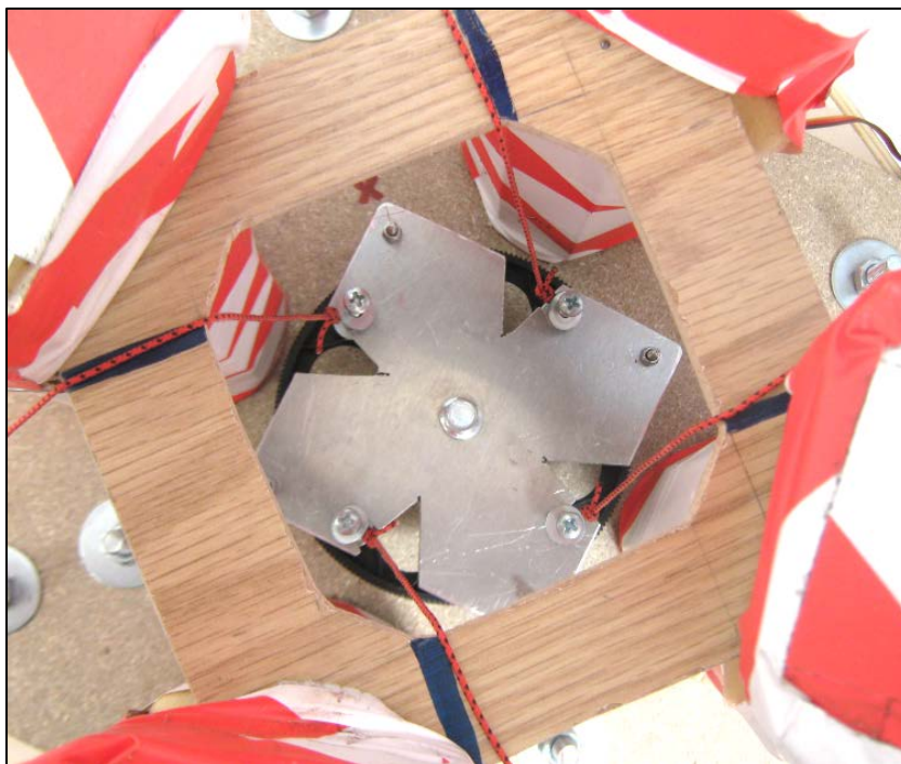
Figura 29: disposizione dei ganci nel sistema di sgancio
