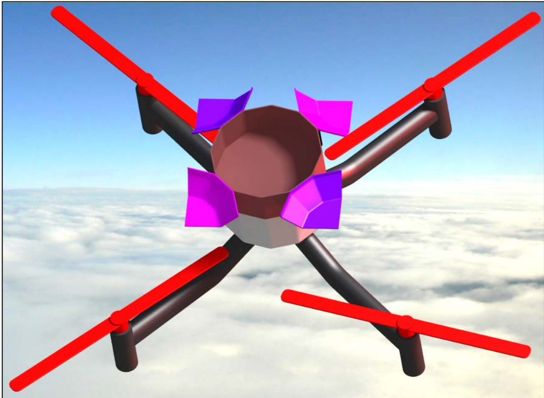
Figura 54: modello CAD del sottosistema integrato sul sistema, contenitore aperto
