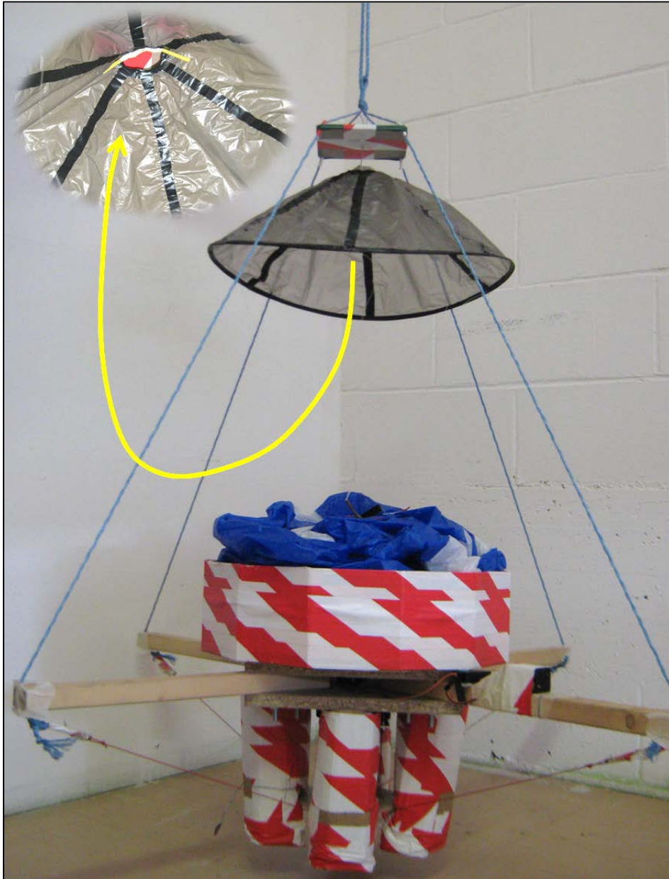
Figura 44: disposizione del paracadute-pilota sul mock-up
