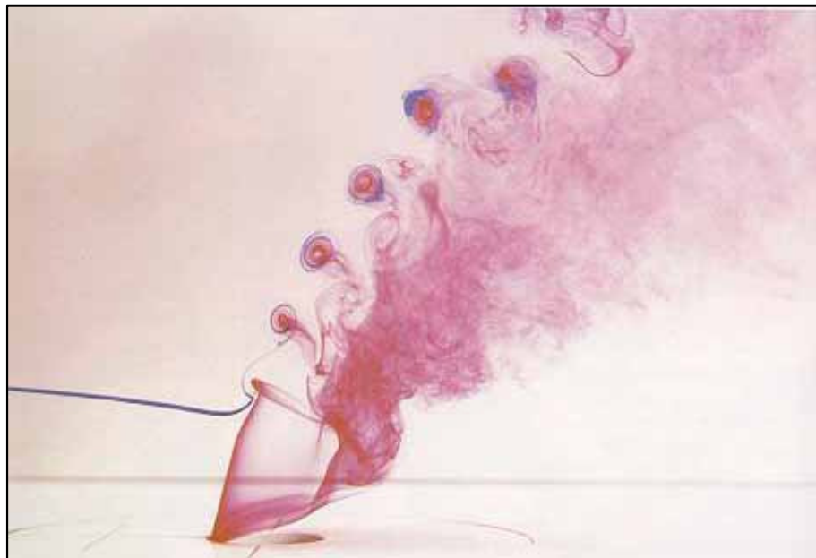
Figura 1.1: Visualizzazione di un getto iniettato perpendicolarmente nel flusso principale [1].
