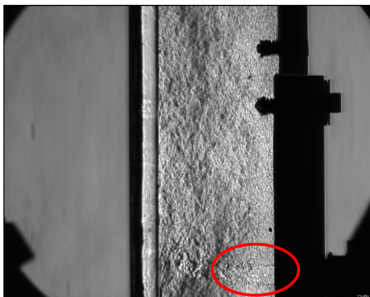
Figura 3.9: Visualizzazione del flusso mediante tecnica Schlieren per un valore di R = 5.92 e Re = 732 . L'ellisse di colore rosso mette in evidenza la presenza del getto nel punto d'iniezione.
