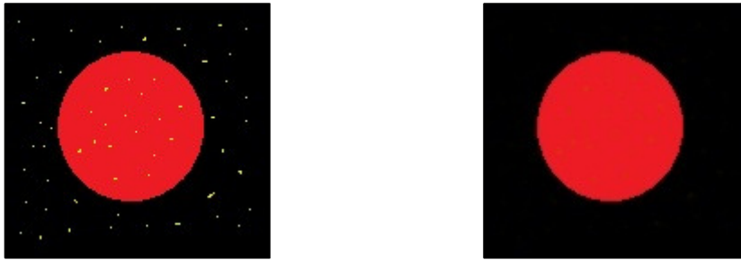
Figura 4.8: Esempio di applicazione di un filtro mediano. Nell'immagine di sinistra è possibile osservare che l'immagine è ricca di punti che rappresentano rumore; la figura a destra invece è stata ottenuta a partire dall'immagine di sinistra a cui è stato applicato un filtro mediano.
