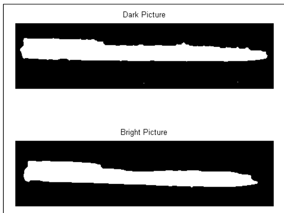
Figura F. 3: Area evidenziata alla fine del processo di elaborazione dell'immagine per la penna presente nelle due foto a differente luminosità mostrate in Figura F. 1.
