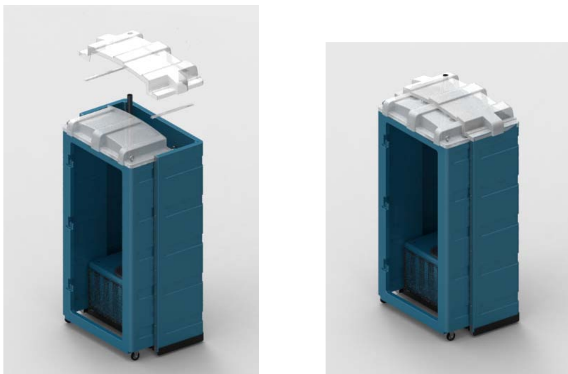
Fig. 88 Assemblaggio del tetto posteriore e delle guide superiori
