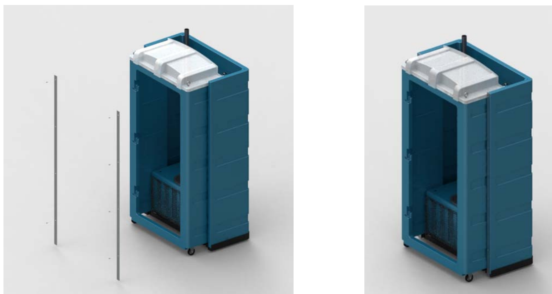
Fig. 87 Assemblaggio degli stipiti
