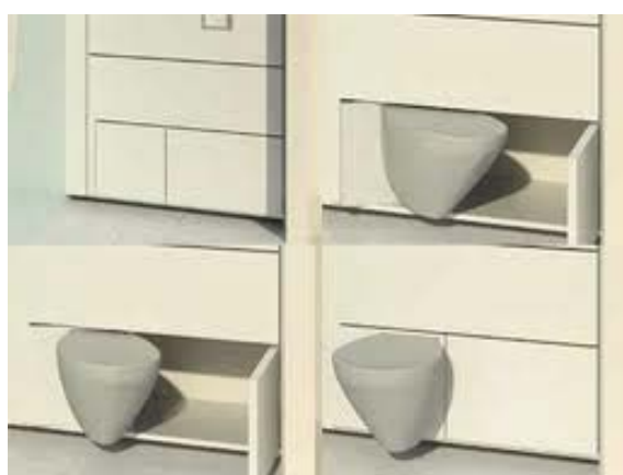
Fig. 20 Wc a scomparsa per pulizia nel vano tecnico
