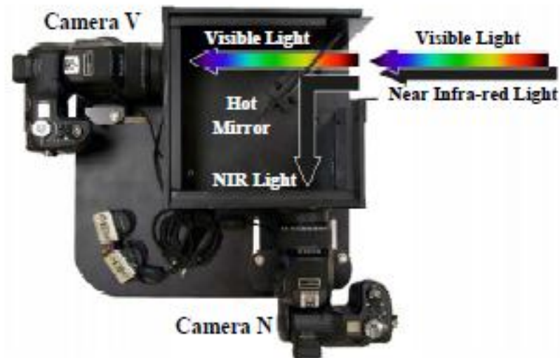
Figura 25 - E' rappresentato un sistema di acquisizione tramite un filtro separa colore, composta dai 2 sistemi di acquisizione, Camera V ed N, e dal filtro separa colore.
