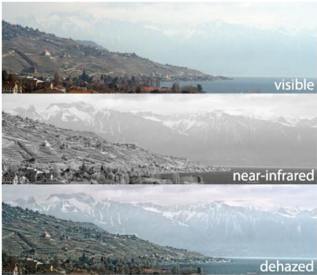
Figura 18 - (In alto) E' rappresentata la scena acquisita solamente tramite le tre risposte spettrali nello spettro visibile. (In centro) E' rappresentata l'immagine tramite l'acquisizione della sola informazione infrarossa. (In basso) E' rappresentata la combinazione delle due acquisizioni tramite algoritmi di post processing [14].
