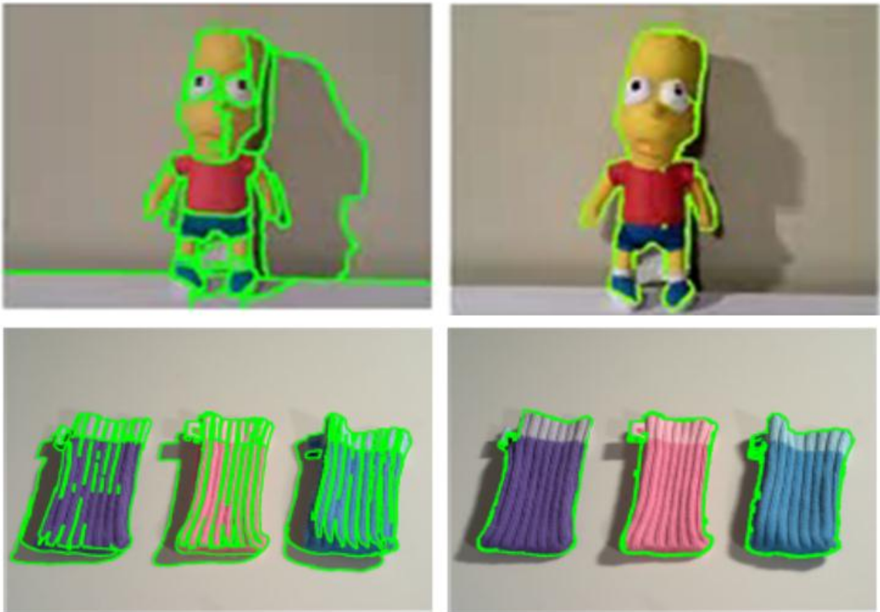
Figura 19 - Nelle 2 immagini a sinistra i contorni, in verde, sono stati identificati attraverso la sola informazione dello spettro visibile. (a destra) I contorni sono stati identificati tramite l'utilizzo dell'informazione infrarossa e visibile.
