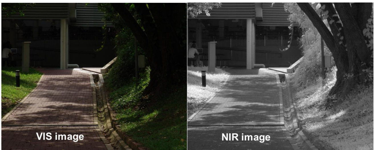
Figura 16 – (Sinistra) Rappresentazione della scena tramite la sola informazione RGB proveniente dallo spettro visibile. (Destra) Rappresentazione della scena tramite la sola informazione misurata dallo spettro NIR [14].
