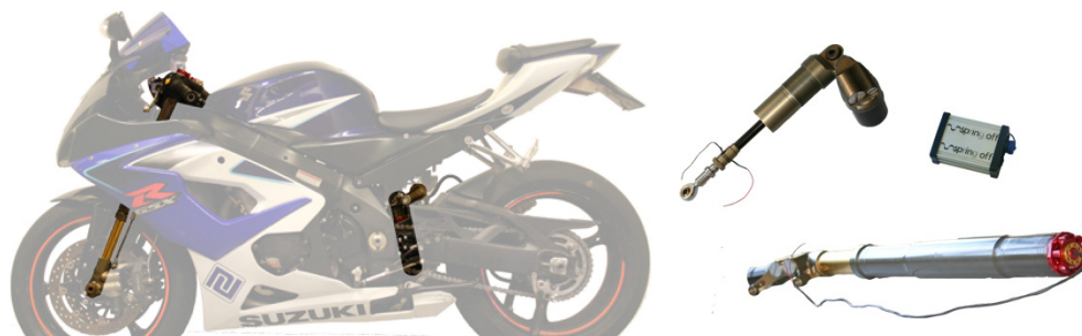
Figura 1.15 Ammortizzatori a fluido magneto-reologico e centralina di controllo SPIDER sviluppati da SpringOff s.r.l.
