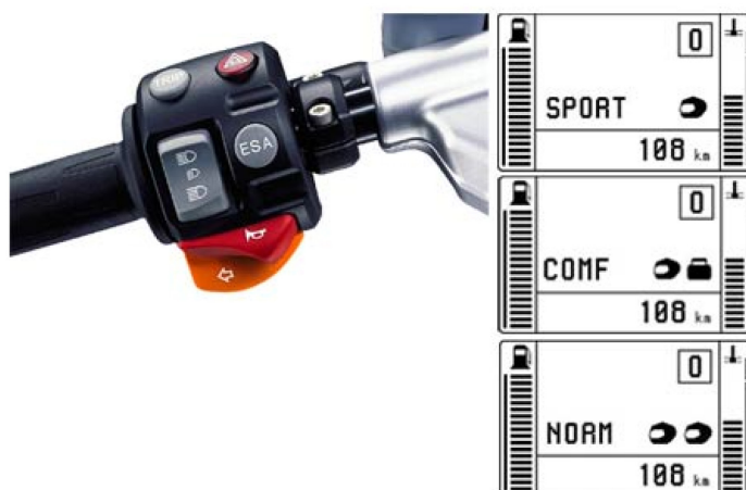
Figura 1.12 BMW ESA, Electroni Suspension Adjustment. Comandi al manubrio e visualizzazione su cruscotto.
