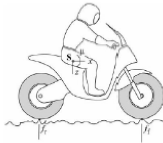
Figura 1.16 Modello multi-body usato per simulare il comportamento del motoveicolo [10]
