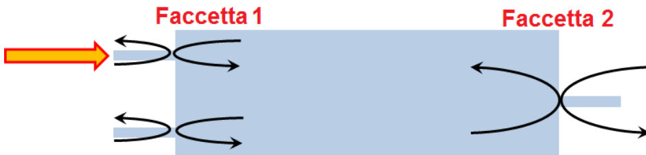
(c) Riflessioni alle porte di un MMI 1 \times 2 utilizzato come accoppiatore di potenza
