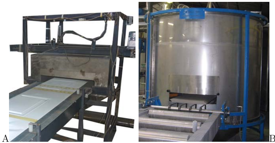
Figura 2.12: Cabine di verniciatura. A: cabina del prototipo; B: cabina per il cliente
