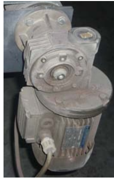
Figura 2.6: Motore e riduttore del nastro trasportatore
