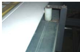
Figura 2.7: Particolare battute in PVC
