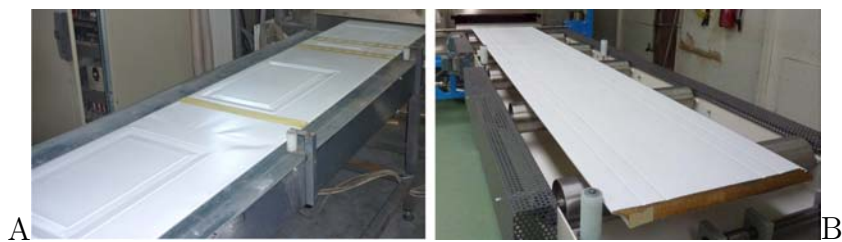
Figura 2.5: Trasportatore meccanico. A sinistra il prototipo, a destra la versione per il cliente in Francia
