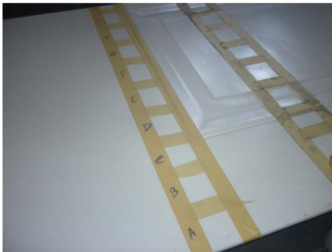
Figura 3.15: Parte di pannello segnata con nastro adesivo per delimitare la zona di misura.
