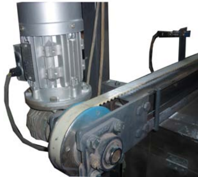
Figura 2.10: Motore del reciprocatore. È ben visibile il cuscinetto a cui è agganciata la puleggia
