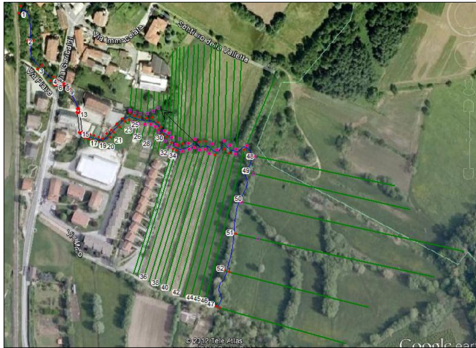
Figura 22 Schematizzazione modello idraulico Renate
