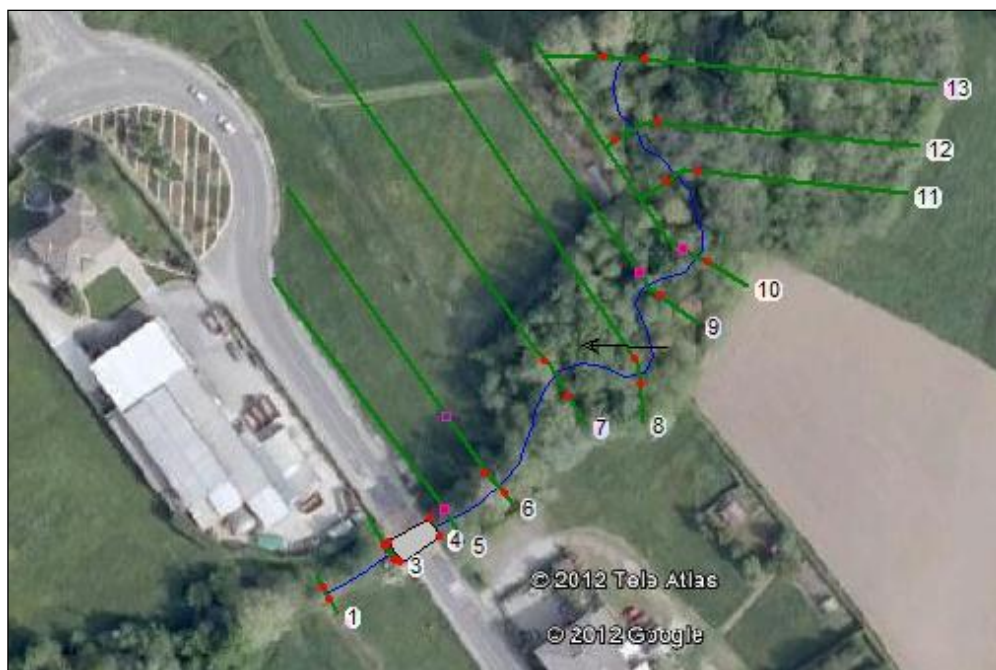
Figura 20 Schematizzazione modello idraulico Monticello Brianza via Bocconi
