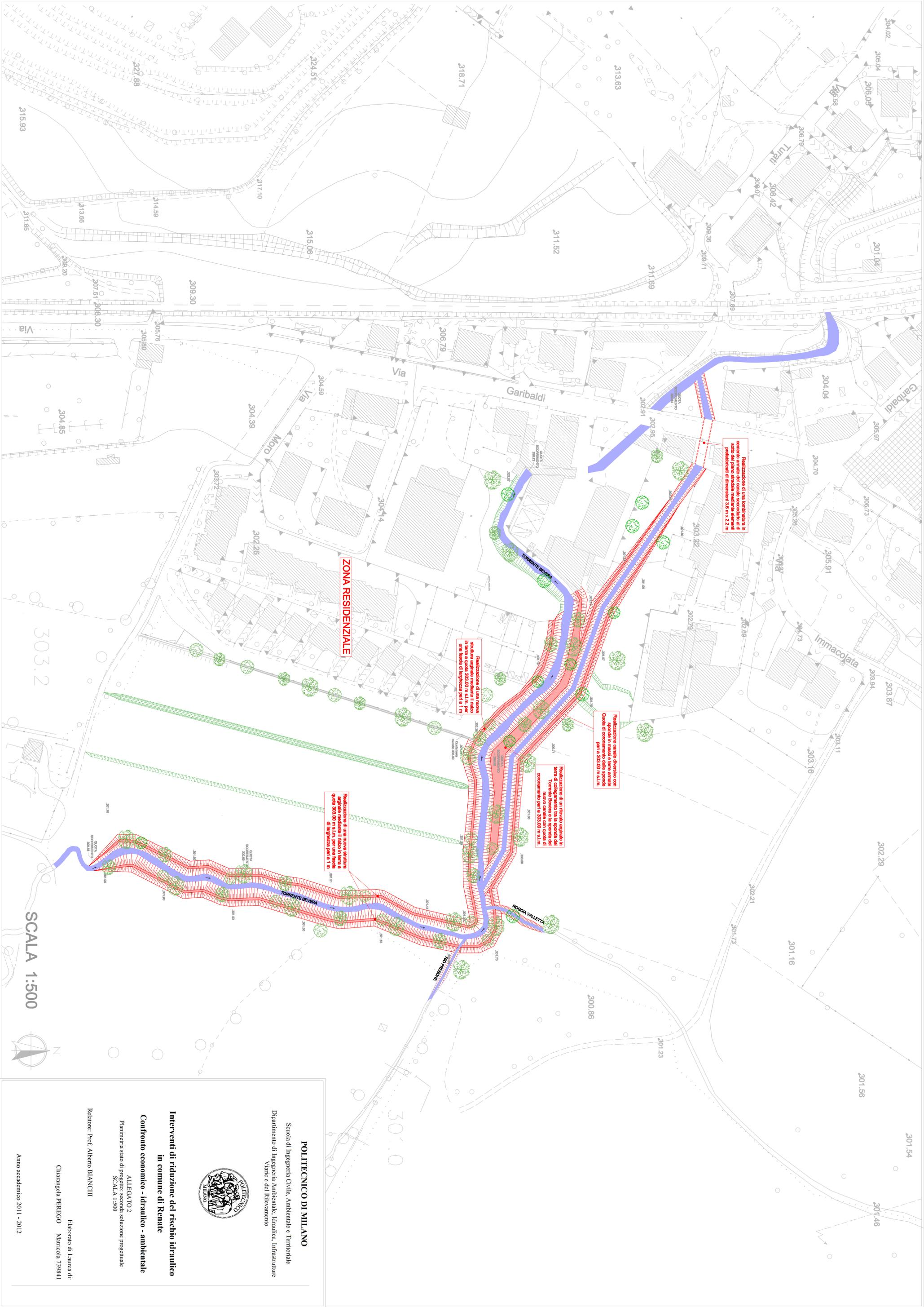
Realizzazione di una sonda in cemento armato del canale secondario al posto del piano stradale mediante elementi prefabbricati di dimensioni 30x70x1,25 m.
