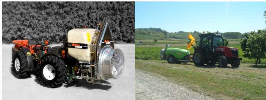
Figura 4.4. Esempio di una macchina operatrice portata (sinistra) e una trasportata (destra). Nello specifico la macchina rappresentata è un atomizzatore.
