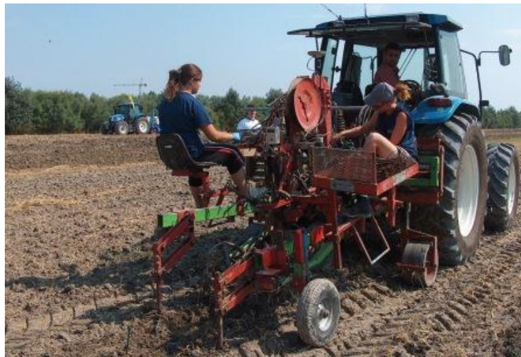
Figura A.3. Immagine rappresentante la trapiantatrice di barbatelle trasportata in funzionamento.
