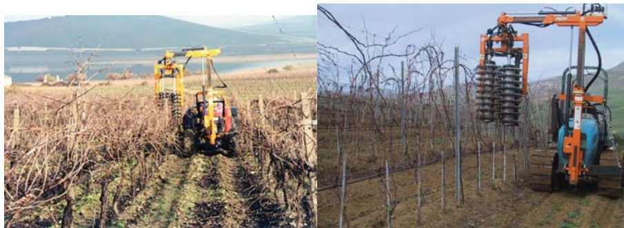
Figura A.6. Due esempi di potatura meccanizzata. A sinistra potatura su cordone speronato, a destra potatura su viti a Guyot.
