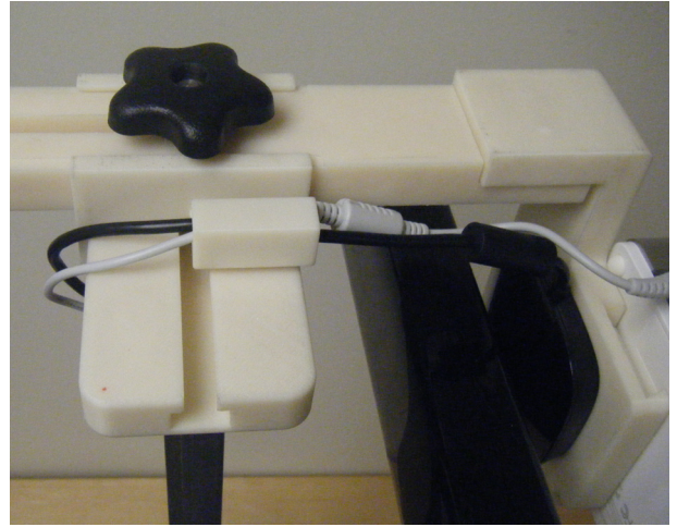
Fig 6.32 | Incastro con due gradi di libertà - prototipo
