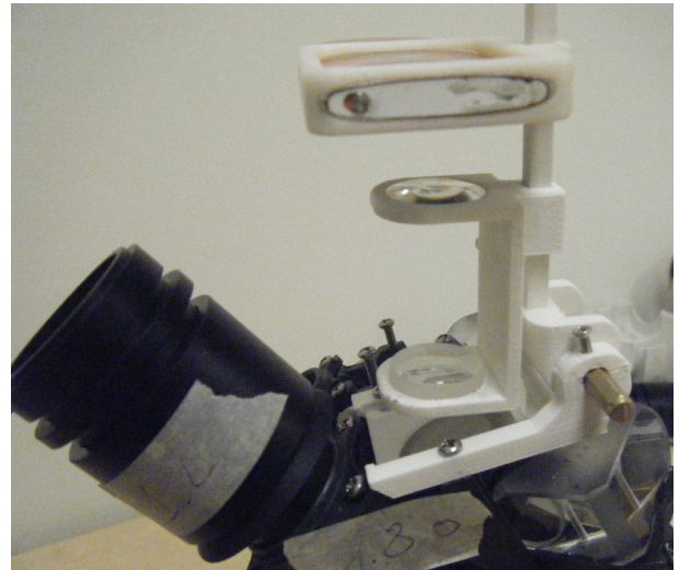
Fig 6.82 I Display e lenti integrate al microscopio
