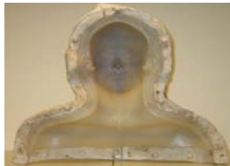
Fig 5.4 | Sequenza creazione manichino, creazione delle stampo da uomo, colata resina e risultato finale
