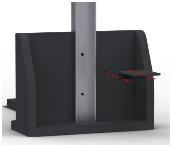
Fig 6.19 | Step 4_Avvitare la base antenna alla parete
