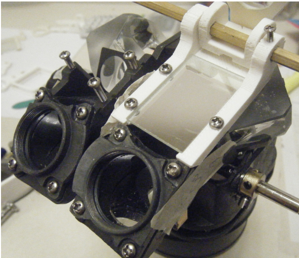
Fig 6.81 Specchio 50 Rif - 50 Ref integrato al microscopio
