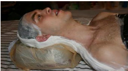
Fig 5.4 | Sequenza creazione manichino, creazione delle stampo da uomo, colata resina e risultato finale
