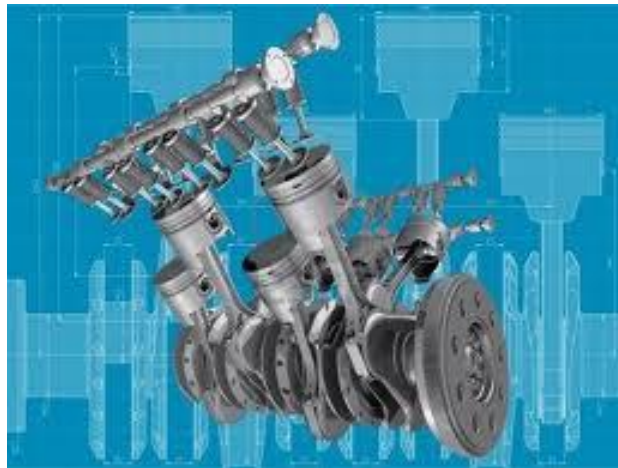
Figura 5.4 – Albero motore con valvole
