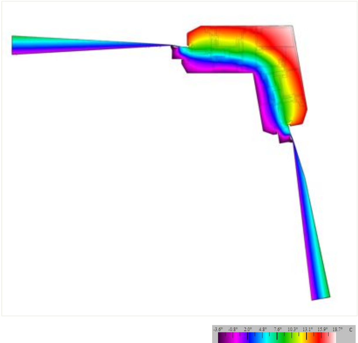
Immagine 9.13– C.T.V. sezione D-D_Risultati cromatici radiazione termica
