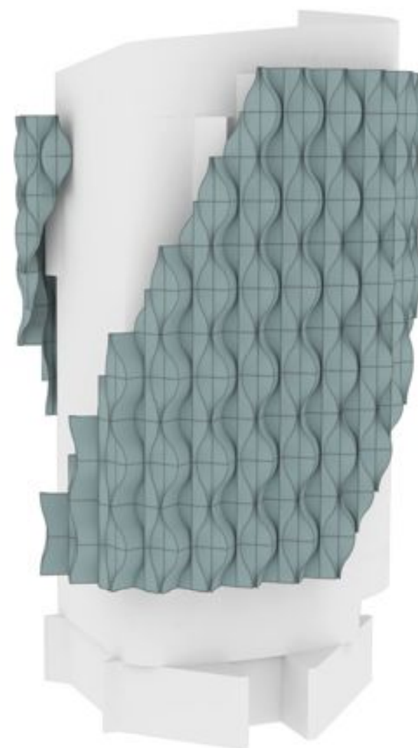
Sistema Seconda pelle vista S-E Configurazione completamente chiusa
