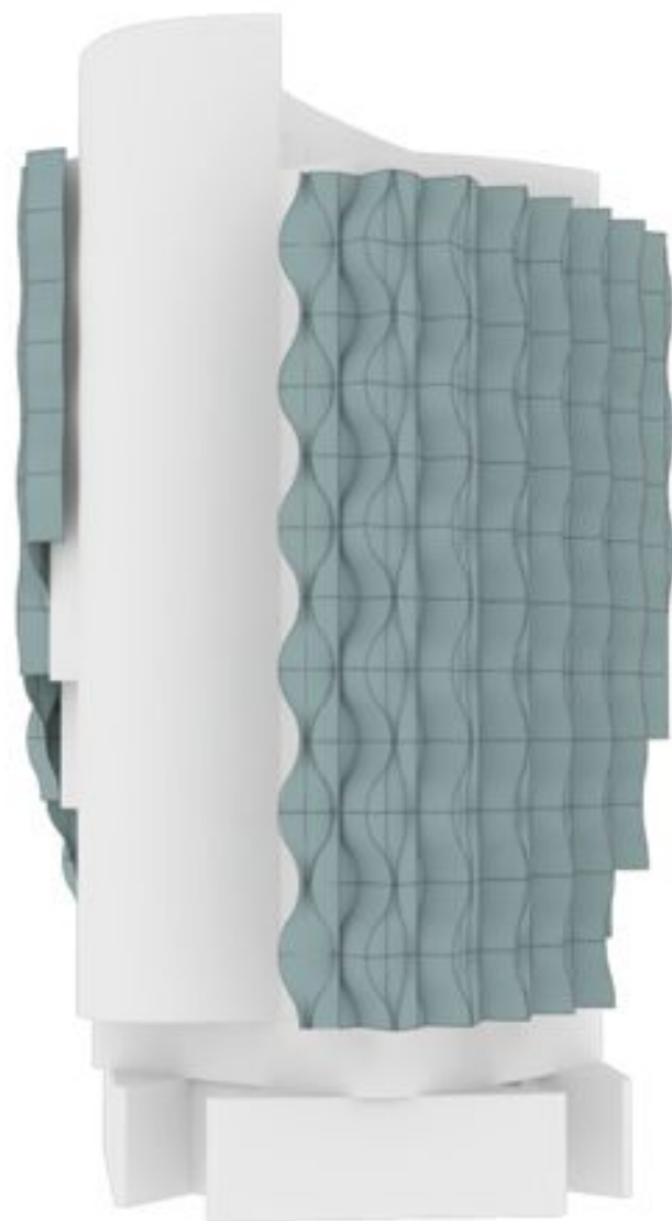
Sistema Seconda pelle vista N-W Configurazione completamente chiusa
