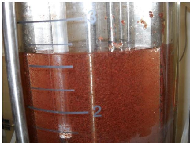
**Figura 3-6 Biomassa inoculata nel fermentatore**
